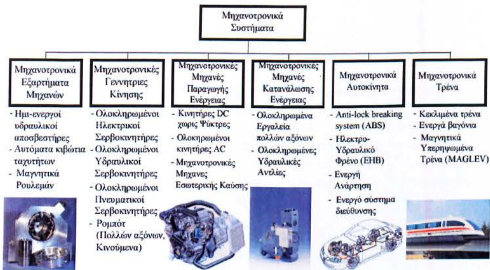
Εικ 1.10. Παραδείγματα κλασικών μηχαντρονικών υποσυστημάτων [32]
