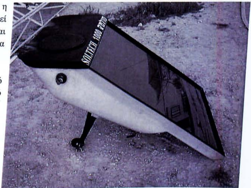
Εικ.4.4. Πειραματικός συλλέκτης-αποθηκη ηλιακής ενέργειας για θέρμανση του νερού [31]
