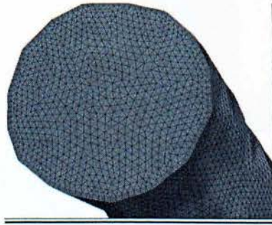
Σχήμα 3.13: Εφαρμογή Υβριδικού Στόματος σε ανθρώπινη φλέβα
