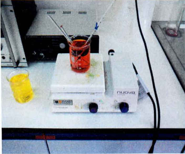
Σχήμα 14. Διάλυμα χρωμοφωσφορικού οξέος για την απομάκρυνση του οξειδίου.
