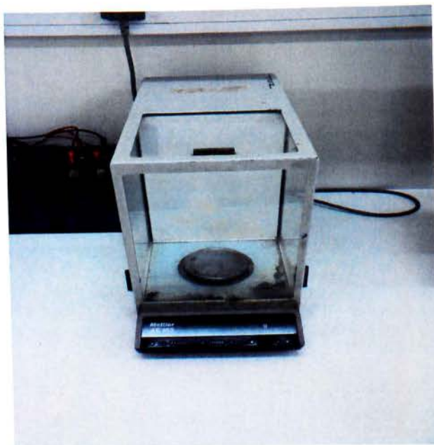
Σχήμα 15. Αναλυτικός ζυγός 5 δεκαδικών ψηφίων ή ευαισθησίας 10^{-5} g.
