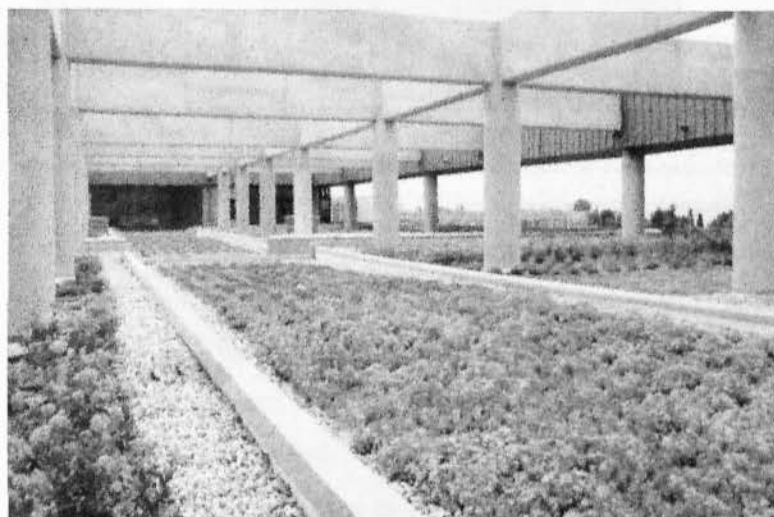
Εικόνα 17: Η ανάπτυξη παχύφυτων και ξηρανθετακών ειδών ελαχιστοποιεί τις ανάγκες άρδευσης και συντήρησης.
