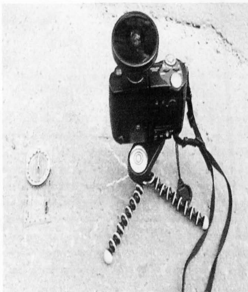
Σχήμα 6: Όργανο λήψης fish eye εικόνων.(Hammerle, Gal, Unger, Matzarakis 2011)
