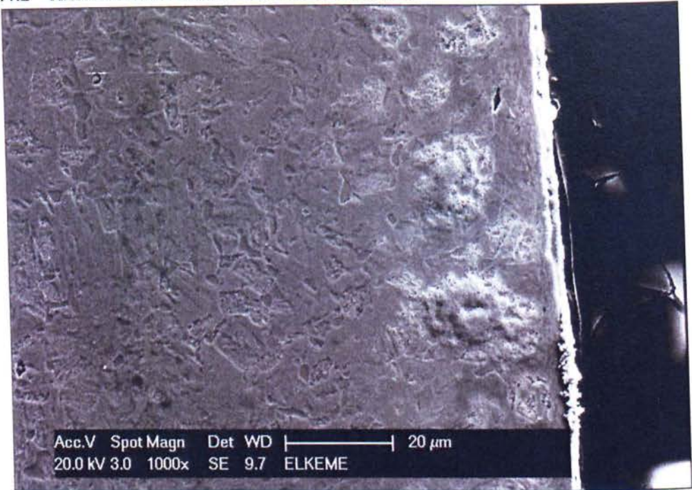
Σχήμα 4.33. Η άκρη της επιφάνειας τριβής του χρησιμοποιημένου δίσκου με το πέδιλο τριβής. Παρατηρείται διαφορά της μικροδομής από την ανάπτυξη της θερμοκρασίας.
