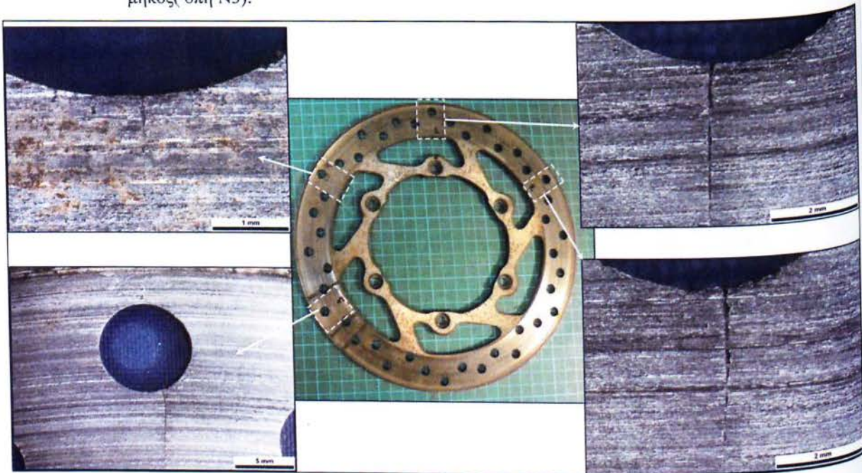
Σχήμα 4.1. Ο μεταχειρισμένος δίσκος και τα σημεία όπου εμφανίστηκαν οι ρωγμές.
