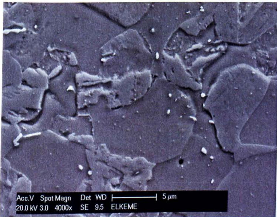
Σχήμα 4.19. Η μικροδομή για τον χρησιμοποιημένο δίσκο στην περιοχή που δεν συμμετέχει σαν τριβασύστημα. Λεπτομέρεια τις 4.18
