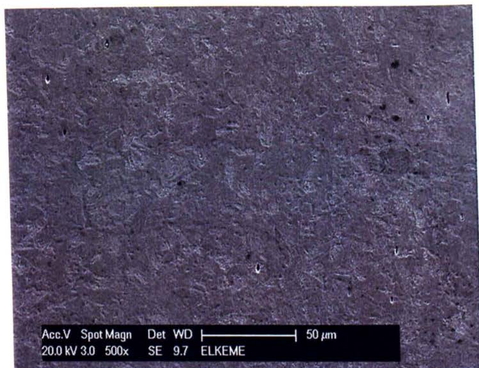
Σχήμα 4.20. Η μικροδομή για τον χρησιμοποιημένο δίσκο στην περιοχή που συμμετέχει σαν τριβασύστημα.
