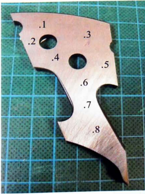
Σχήμα 4.67. Τα σημεία των μετρήσεων της σκληρομέτρησης.
