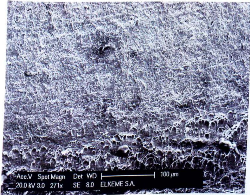
Σχήμα 4.52. Η επιφάνεια όλκιμης θραύσης(ductile dimples) της τελικής φόρτισης. Λεπτομέρεια της 4.51
