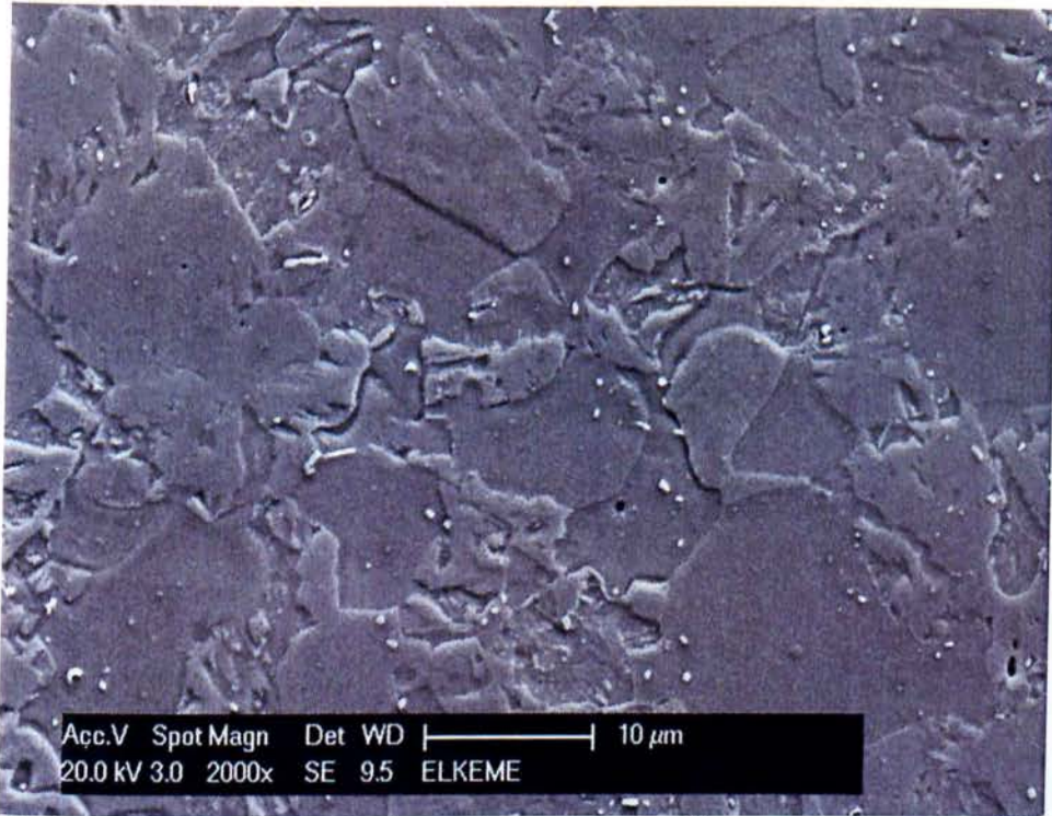
Σχήμα 4.18. Η μικροδομή για τον χρησιμοποιημένο δίσκο στην περιοχή που δεν συμμετέχει σαν τριβασύστημα. Λεπτομέρεια τις 4.17
