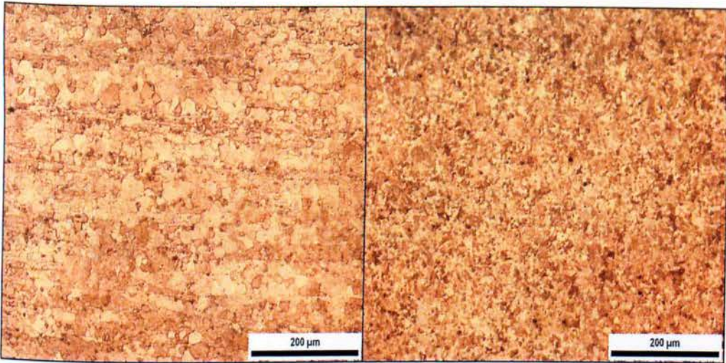
Σχήμα 4.9. Η μικροδομή για το μεταχειρισμένο δίσκο πέδης με μεγέθυνση X200.
