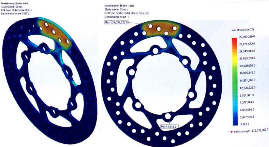
Σχήμα 4.71. Η κατανομή των τάσεων σε N/m^2 .
