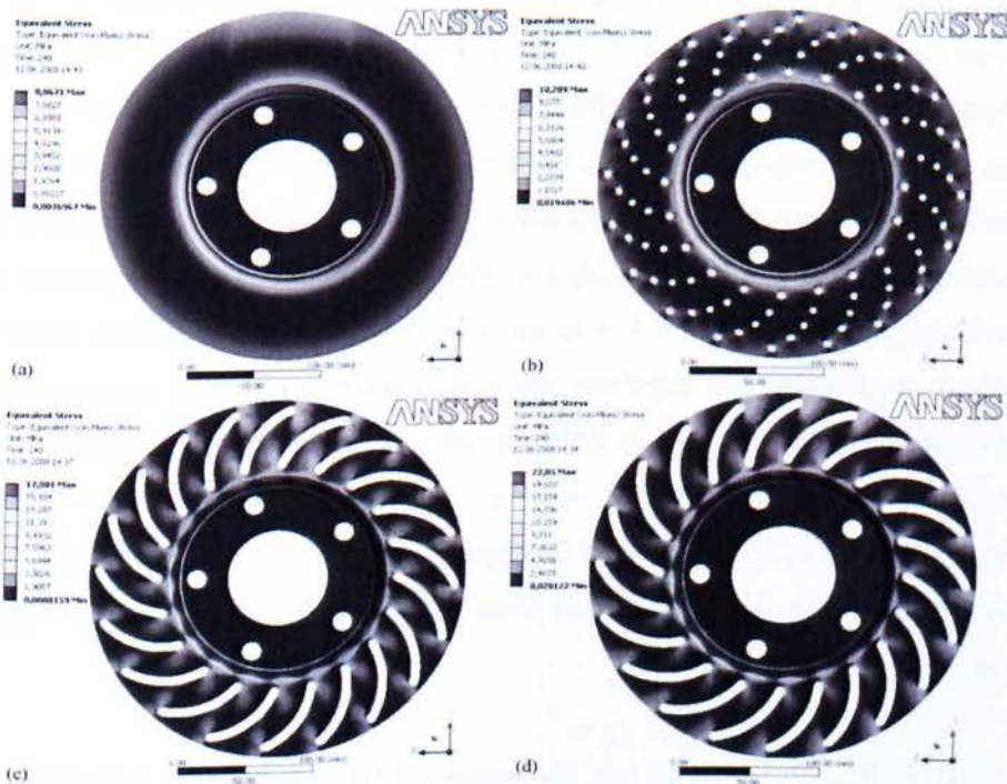
Σχήμα 2.9 Προσομοίωση των αποτελεσμάτων της ανάλυσης, a) SL disk, b) CD disk, c) CS disk, d) CS-SG disk.
