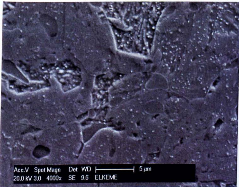
Σχήμα 4.24. Η μικροδομή για τον χρησιμοποιημένο δίσκο στην περιοχή που συμμετέχει σαν τριβοσύστημα. Λεπτομέρεια τις 4.23
