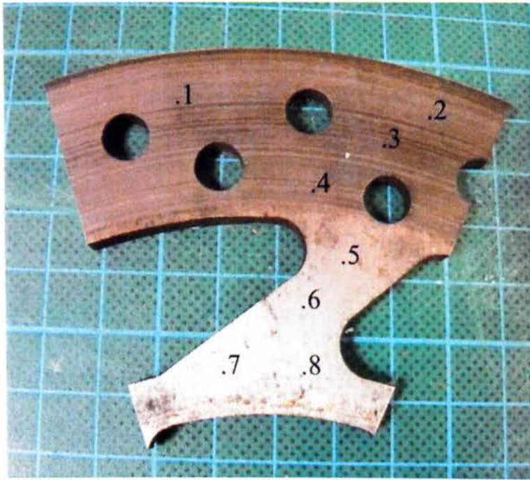
Σχήμα 4.66. Τα σημεία των μετρήσεων της σκληρομέτρησης.
