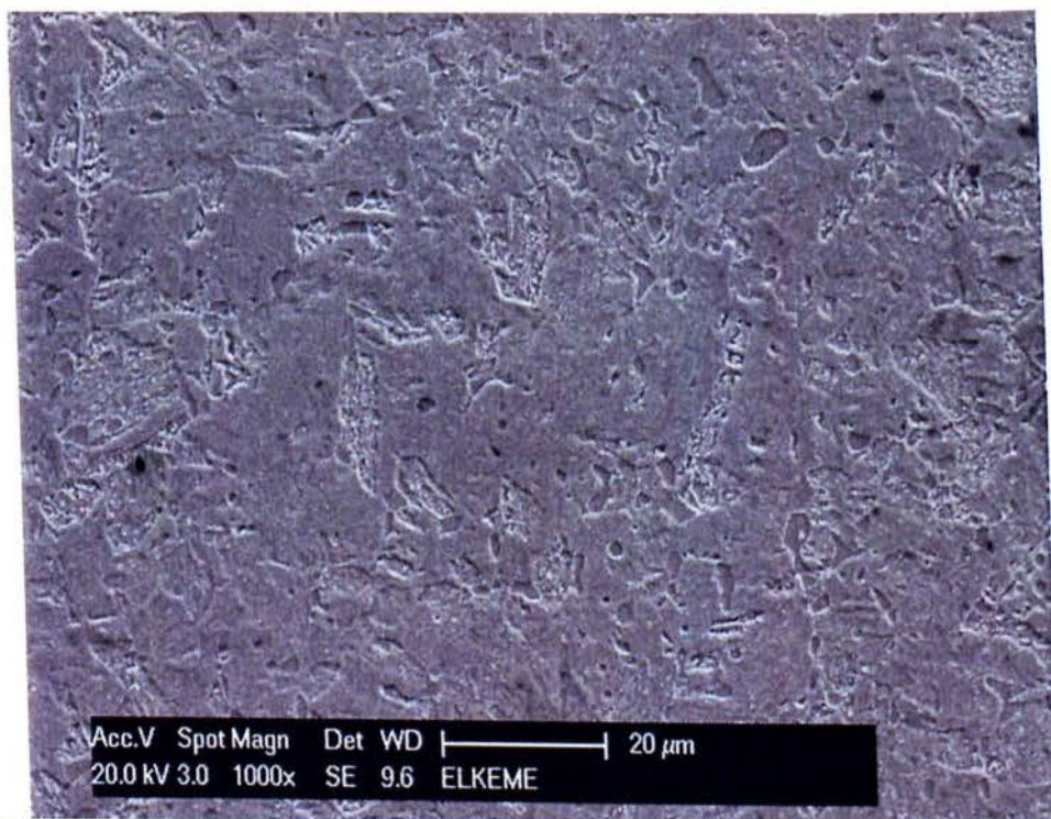
Σχήμα 4.22. Η μικροδομή για τον χρησιμοποιημένο δίσκο στην περιοχή που συμμετέχει σαν τριβασύστημα. Λεπτομέρεια τις 4.21
