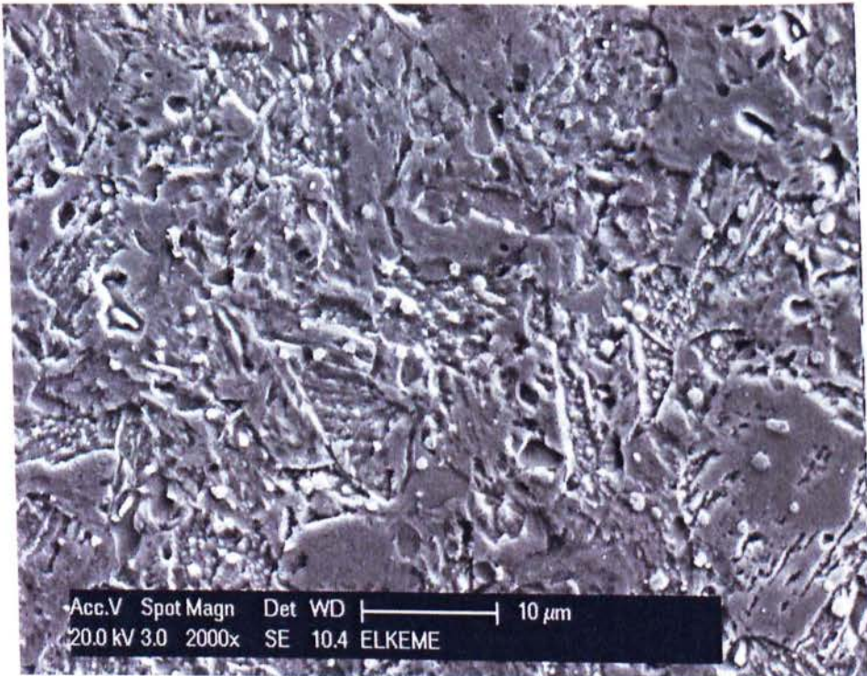
Σχήμα 4.30. Η μικροδομή για τον μη χρησιμοποιημένο δίσκο στην περιοχή που συμμετέχει σαν τριβοσύστημα. Λεπτομέρεια τις 4.29
