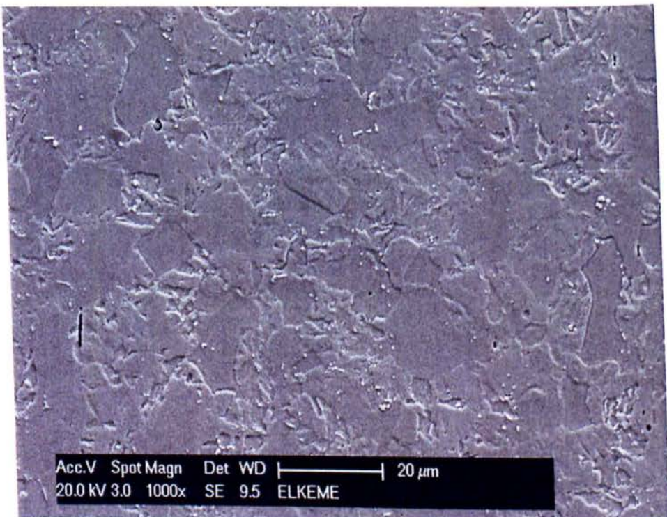
Σχήμα 4.17. Η μικροδομή για τον χρησιμοποιημένο δίσκο στην περιοχή που δεν συμμετέχει σαν τριβοσύστημα. Λεπτομέρεια τις 4.16
