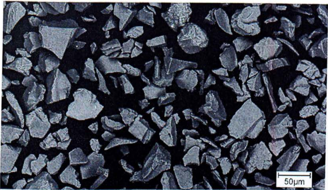
Σχήμα 5.2.4 Μορφολογία και γεωμετρία κόκκων ζιρκονίας
