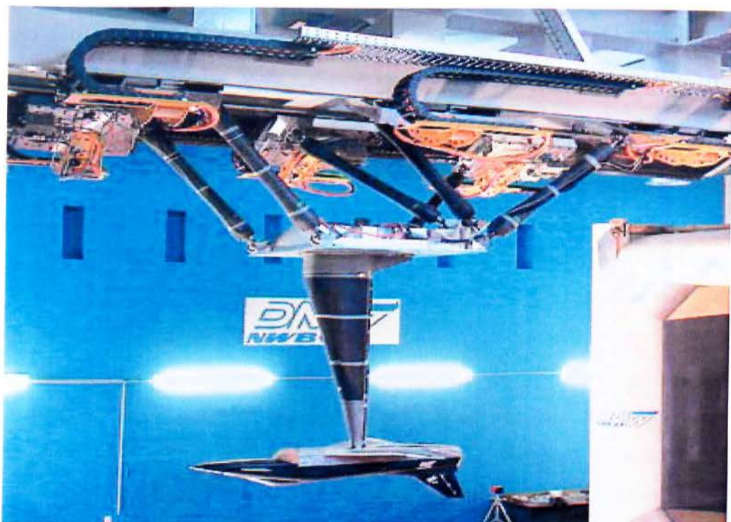
εικόνα 1.2.2: διάταξη μετατόπισης μοντέλου, εντός του ανοικτού θαλάμου δοκιμών της κλειστού κυκλώματος αεροσήραγγας του Γερμανό-Ολλανδικού Οργανισμού (DNW) στο Braunschweig της Γερμανίας.
