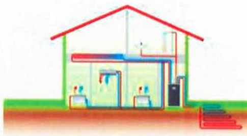
Κλειστό κύκλωμα με οριζόντιους βρόγχους
