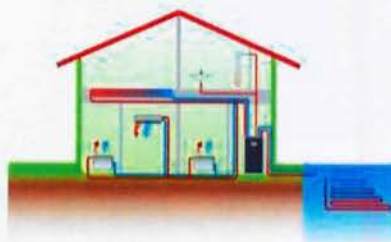
Κλειστό κύκλωμα με βρόγχους σε πηγάδι, λίμνη ή θάλασσα
