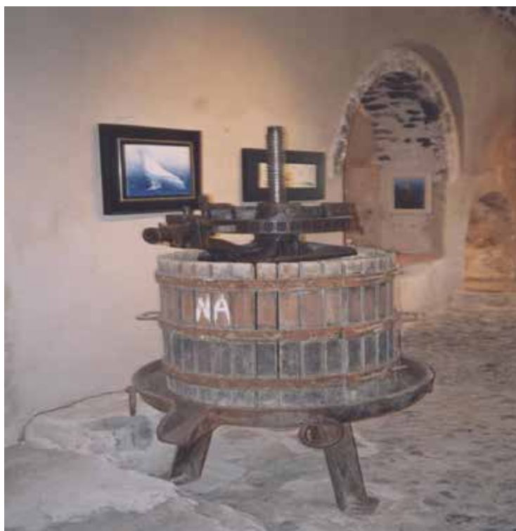
εικ.13 Μηχανικό Χειροκίνητο Πατητήρι μέσα στο οποίο μπαίνουν τα τσάμπουρα για την αποχύμωσή τους για την παρασκευή της ρακίς.
