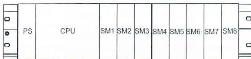
Σχήμα 1.3.1 Ένα Rack με ένα PLC και 8 κάρτες εισόδων / εξόδων
