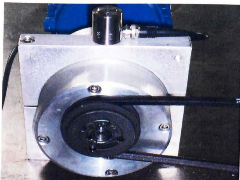
Μέτρηση για έλεγχο VIB του αυξηνητήρα και την ανάλυση EVAM στο πρόγραμμα με το επιταχυνσιομέτρο να τοποθετείται στην κατακόρυφη θέση
