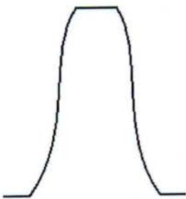
Μορφή δοντιού με εξειλιγμένη
