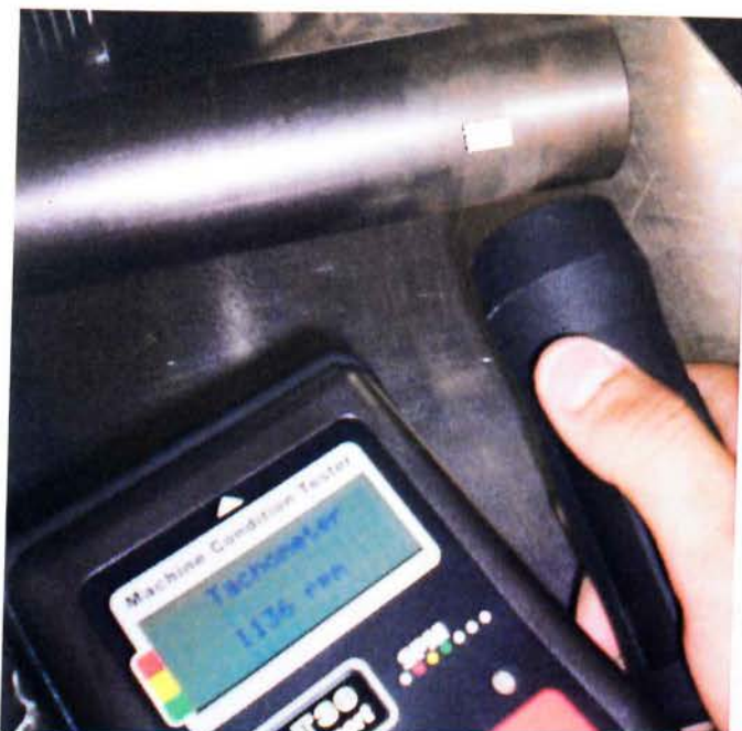
Μέτρηση της περιστροφικής ταχύτητας στον άξονα με το όργανο T-30 προσαρμόζοντας τον κατάλληλο αισθητήρα
