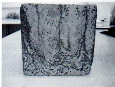
Εικόνα 5.12: Κυβικό δοκίμιο ΕΑΣ με ΤΠΜελ προς μέτρηση αντοχής σε θλίψη.
