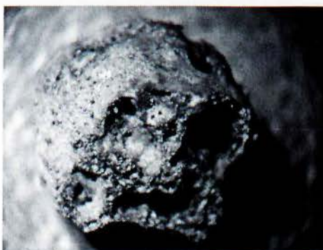
Εικόνα 5.6. Άποψη πυροσυσσωματωμένου σωματιδίου σε στερεοσκόπιο.
