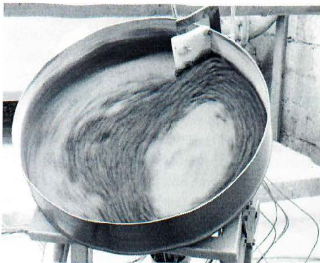
Εικόνα 4.6. Στάδιο σφαιροποίησης μινμάτων ΤΠ και ΙΤ.
