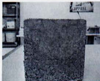
Εικόνα 5.13: Κυβικό δοκίμιο ΕΑΣ με ΜΜεγ1 προς μέτρηση αντοχής σε θλίψη.
