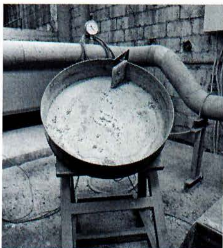
Εικόνα 4.2. Περιστρεφόμενος δίσκος πελλετοποίησης.
