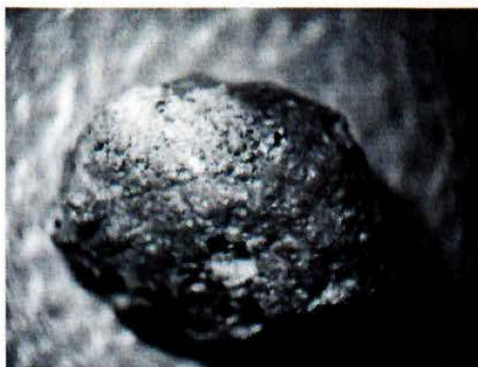
Εικόνα 2.16. Άποψη υαλώδους φάσης στο εξωτερικό του σφαιριδίου
