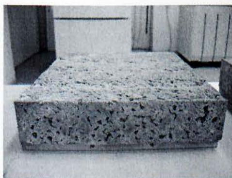
Εικόνα 5.15: Δοκίμιο ΕΑΣ με ΤΠΜελ προς μέτρηση συντελεστή αγωγιμότητας.
