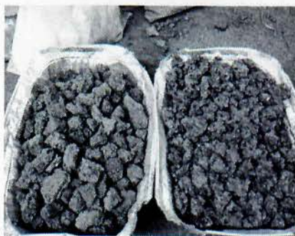
Εικόνα 5.8: ΤΠΜελ >8mm (αριστερά) και ΜΜεγ1 (δεξιά) θραυσμένο σε κοκκομετρία 10-16mm.
