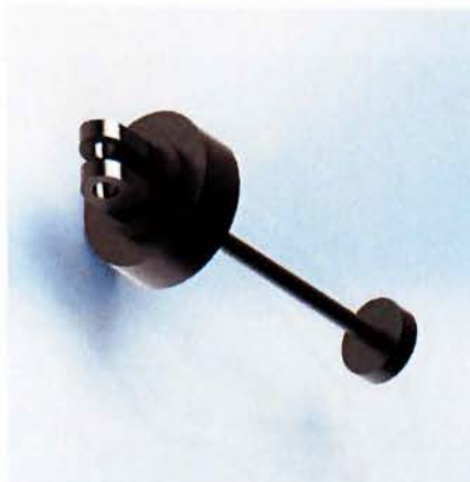
Εικόνα 49: Φωτορεαλιστική απεικόνιση κάτω μέρους αμορτισέρ της μοτοσυκλέτας
