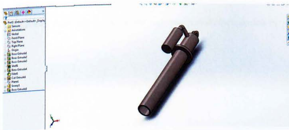
Εικόνα 44: Απεικόνιση σχεδίασης πάνω μέρους αμορτισέρ της μοτοσυκλέτας
