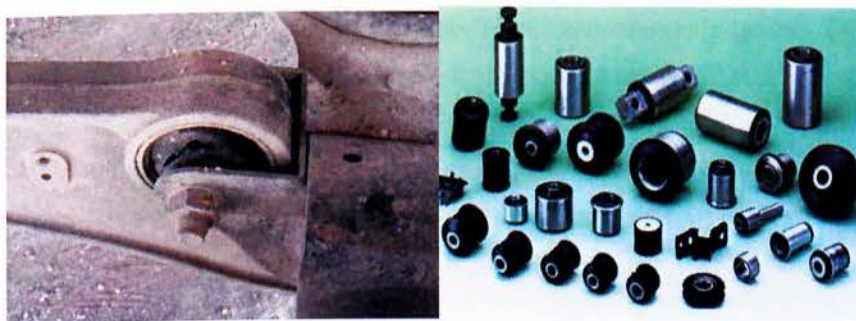
Εικόνα 12: Μεταλλοελαστικοί σύνδεσμοι σινεμπλόκ
