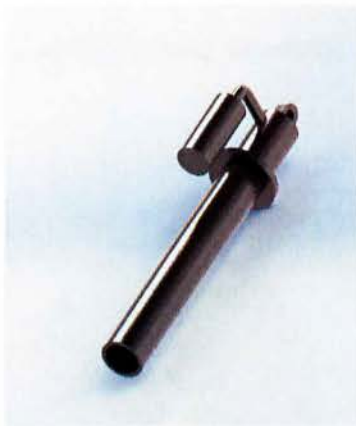
Εικόνα 45: Φωτορεαλιστική απεικόνιση σχεδίασης πάνω μέρος αμορτισέρ της μοτοσυκλέτας
