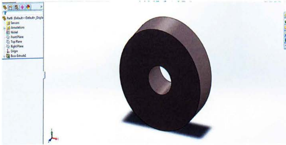
Εικόνα 46: Απεικόνιση σχεδίασης στεγανοποιητικού πάνω μέρους αμορτισέρ της μοτοσυκλέτας
