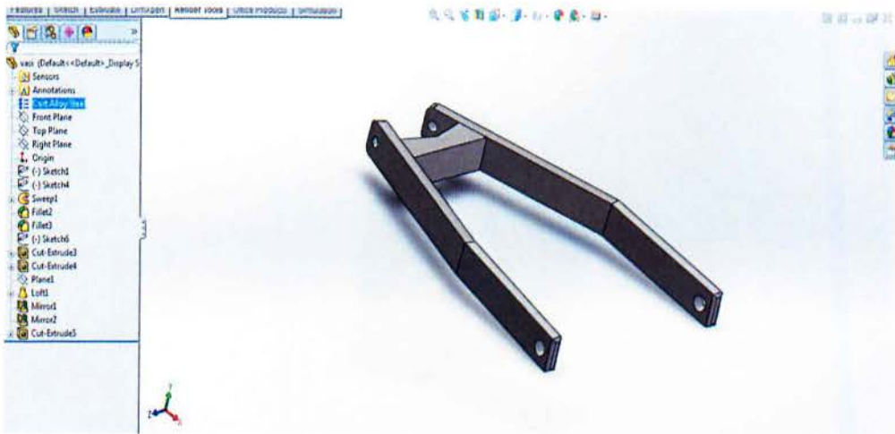
Εικόνα 67: Απεικόνιση σχεδίασης πηρουιού της μοτοσυκλέτας
