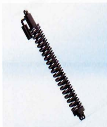
Εικόνα 72: Φωτορεαλιστική απεικόνιση συναρμολογημένης διάταξης αμορτισέρ
