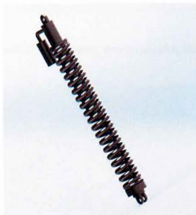
Εικόνα 38 Φωτορεαλιστική απεικόνιση συναρμολογημένης διάταξης αμορτισέρ
