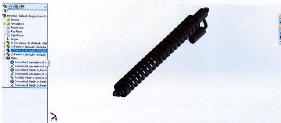
Εικόνα 37: Απεικόνιση συναρμολογημένου αμορτισέρ της μοτοσυκλέτας
