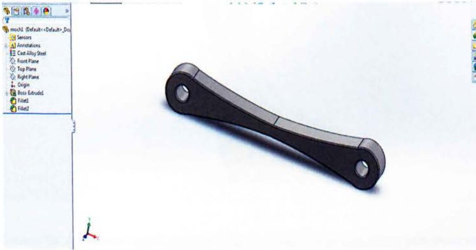
Εικόνα 56: Απεικόνιση σχεδίασης άρθρωσης μοχλικού συστήματος της μοτοσυκλέτας
