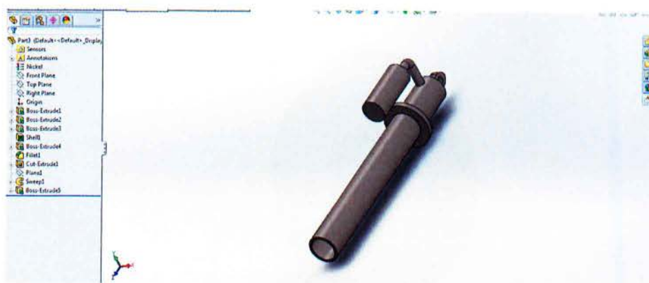
Εικόνα 78: Απεικόνιση σχεδίασης πάνω μέρος αμορτισέρ της μοτοσυκλέτας
