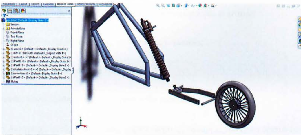
Εικόνα 65: Απεικόνιση αποσυναρμολογημένης διάταξης συστήματος PDS
