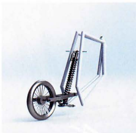
Εικόνα 33: Φωτορεαλιστική απεικόνιση συναρμολογημένης διάταξης μοχλικού συστήματος
