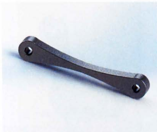
Εικόνα 57: Φωτορεαλιστική απεικόνιση άρθρωσης μοχλικού συστήματος της μοτοσυκλέτας
