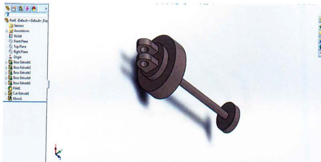
Εικόνα 82: Απεικόνιση σχεδίασης κάτω μέρους αμορτισέρ της μοτοσυκλέτας
