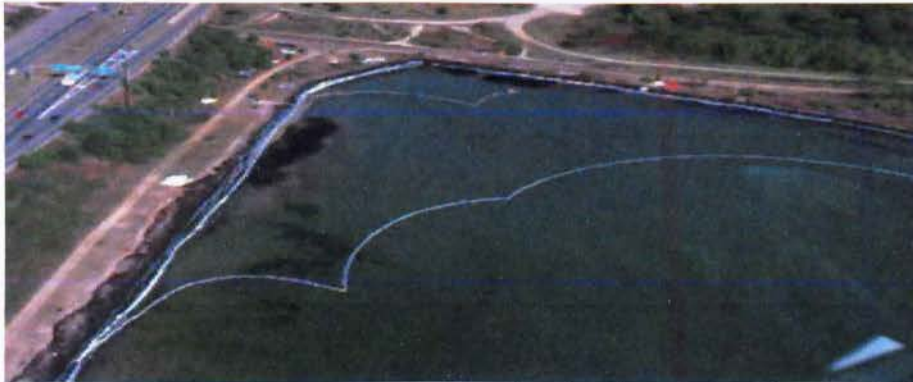
Εικόνα 13: Ο κόλπος Casco Bay, που στις 27 Σεπτεμβρίου του 1996 μολύνθηκε από την έκλυση πετρελαίου ενός τάνκερ, περιφραγμένος από τα ειδικά φράγματα για τον περιορισμό της μόλυνσης. Η κινητοποίηση ήταν άμεση και η μόλυνση περιορίστηκε στο ελάχιστο.
