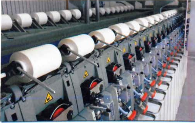
Εικόνα 9: Κλώστρια. Η μηχανή που λεπταίνει το πρόνημα, του προσδίδει στρίψεις και περιτυλίγει το τελικό προϊόν, δηλαδή το νήμα.
