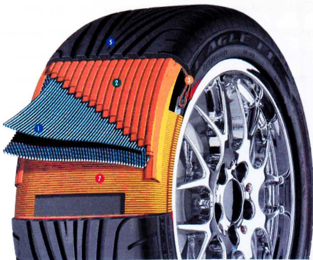
Σχήμα 29. Η ζώνη αποτελείται από διάφορες στρώσεις ειδικών ινών (1 και 2), τα λινά (7) απλώνονται ακτινωτά και δένονται γύρω από τη στεφάνη (3), η γόμα (5) είναι το υλικό που περιβάλλει το ελαστικό [17]
