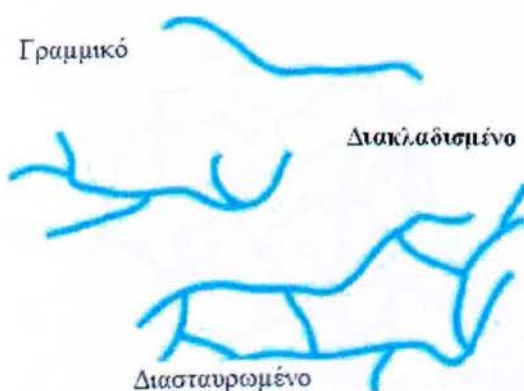
Σχήμα 4. Γραμμικό, διακλαδισμένο και διασταυρωμένο πολυμερές
