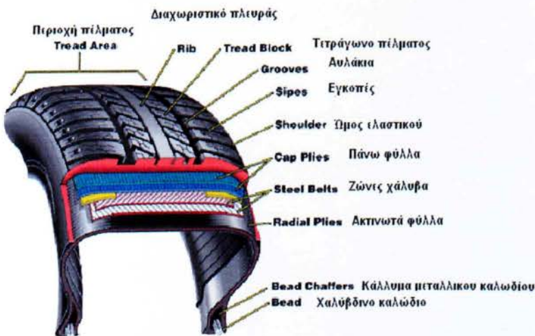
Σχήμα 31. Ονοματολογία τμημάτων ενός ελαστικού
