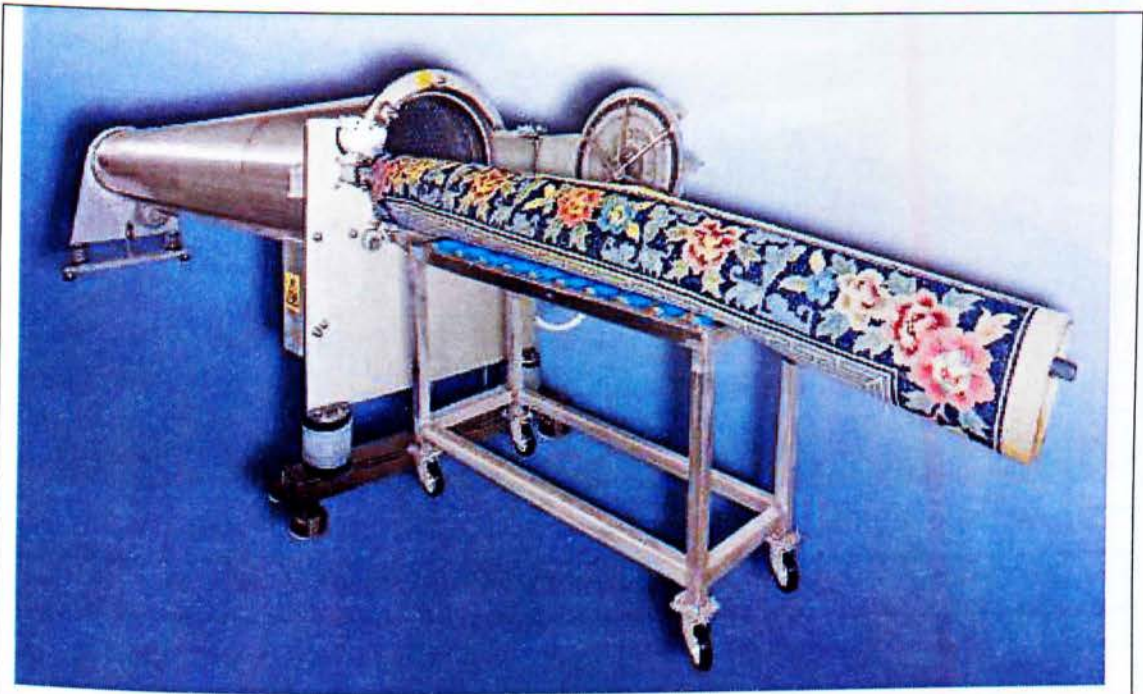
Εικόνα 13: Φυγοκεντρικό μηχάνημα στυψίματος
