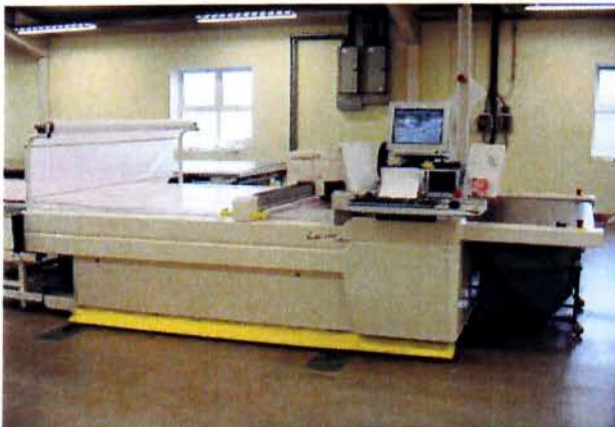
Εικόνα 30 : Κοπτήριο συνδεδεμένο με Η/Υ
