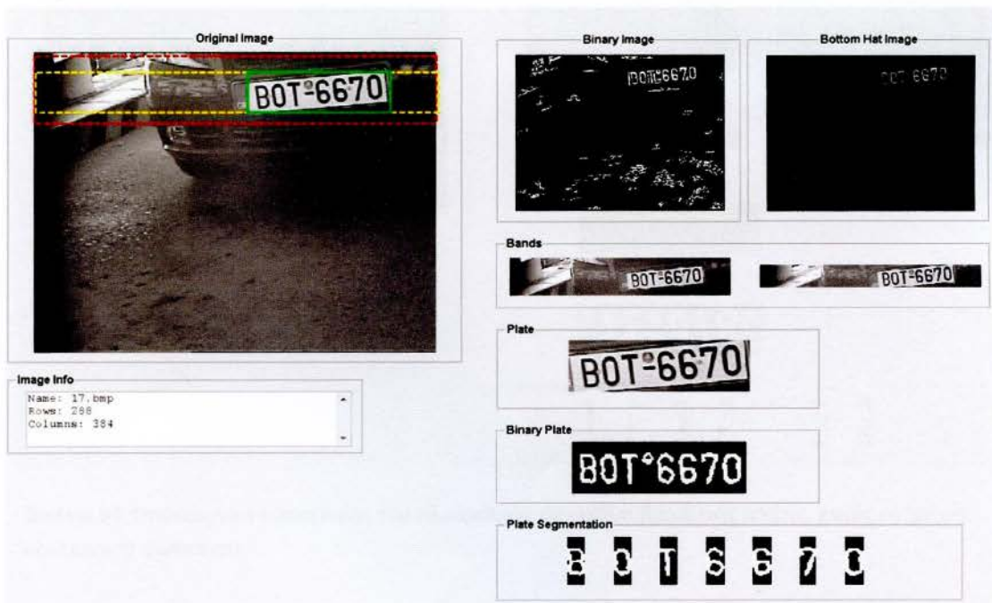
Εικόνα 92 Παράδειγμα εφαρμογής του αλγορίθμου με κλίση πινακίδας.
