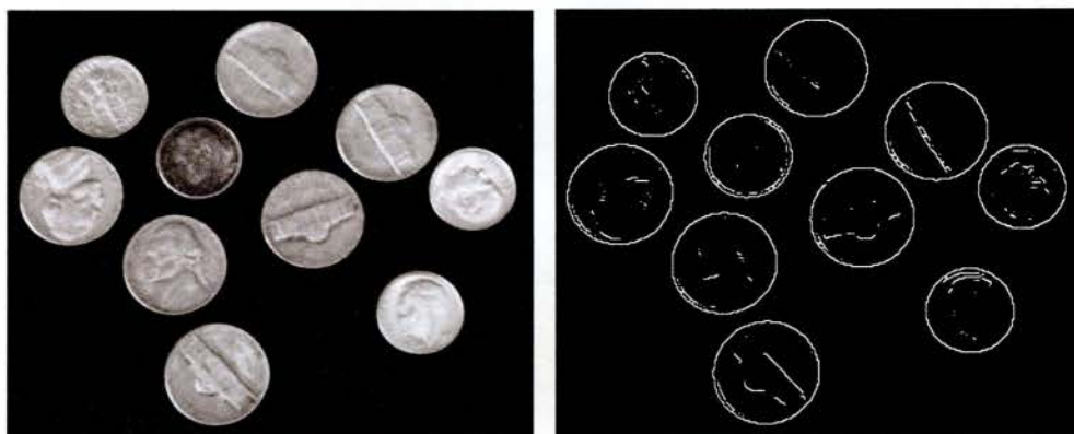
Εικόνα 4 Ανίχνευση ακμών σε μία εικόνα. (α) Αρχική εικόνα. (β) Εφαρμογή ανίχνευσης ακμών.
