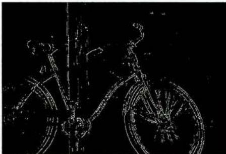
Εικόνα 62 (α) Αρχική εικόνα. (β) Ανίχνευση ακμών με τη χρήση και των δύο τελεστών ( G_y, G_x ). (γ) Κάθετη ανίχνευση ακμών ( G_y ). (δ) Οριζόντια ανίχνευση ακμών ( G_x ).
