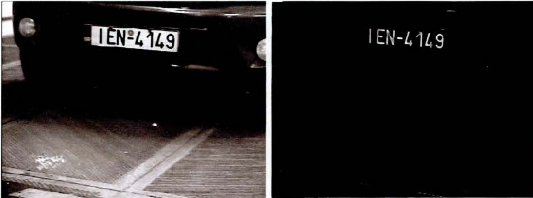
Εικόνα 73 (α) Αρχική εικόνα. (β) Εφαρμογή φίλτρου bottom hat.
