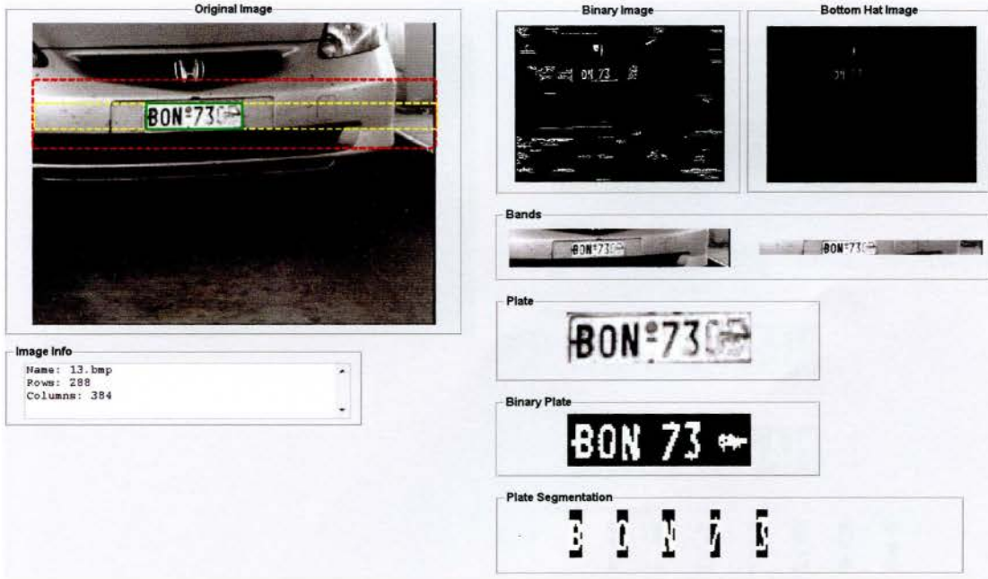
Εικόνα 95 Παράδειγμα εφαρμογής του αλγόριθμου σε φθαρμένη πινακίδα.
