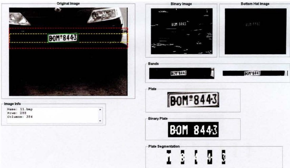
Εικόνα 96 Παράδειγμα εφαρμογής του αλγόριθμου σε πινακίδα με ύπαρξη βίδας ανάμεσα στους χαρακτήρες.
