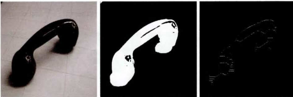
Εικόνα 51 (α) Αρχική εικόνα. (β) Δυαδική εικόνα. (γ) Σκελετοποιημένη εικόνα.
