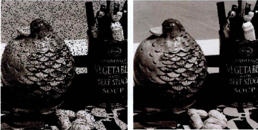
Εικόνα 2 Αφαίρεση του θορύβου από μία εικόνα. (α) Αρχική εικόνα. (β) Η εικόνα μετά την αφαίρεση του θορύβου.
