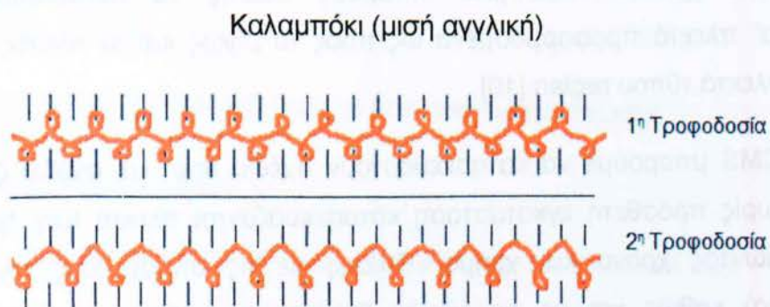
Σχήμα 3.8: Πορεία νήματος στις βελόνες
