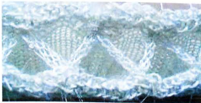
Εικόνα 2.4: Spacer fabric με συνδέσεις σχήματος V [7]
