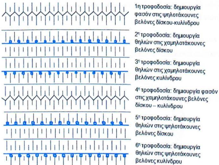
Σχήμα 2.4: Πορεία νήματος στις βελόνες ενός spacer fabrics [3,7].
