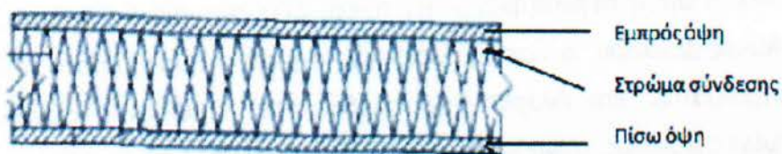
Εικόνα 2.3: άποψη της διατομής ενός spacer fabrics [5]
