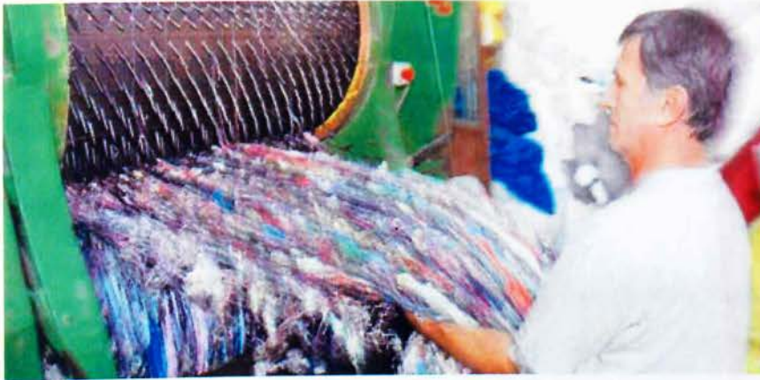
Εικόνα 4.1- Ειδικό μηχάνημα που χτενίζει τα ρούχα με ένα χτένι μέχρι να μείνουν μόνο ίνες
