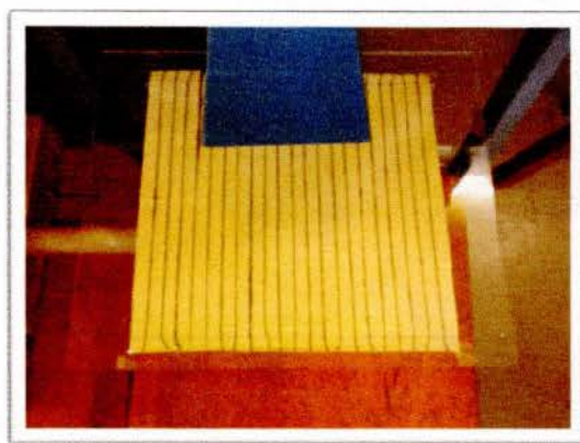
Εικόνα 9: Υφαντό ύφασμα με αγώγιμα νήματα που χρησιμοποιήθηκε στο πείραμα
