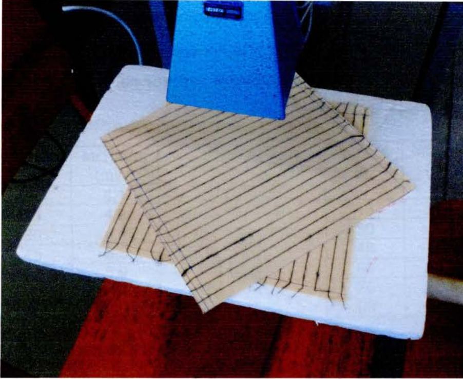
Εικόνα 12 : Μέτρηση ισχύος ηλεκτρομαγνητικών κυμάτων σε διπλό ύφασμα
