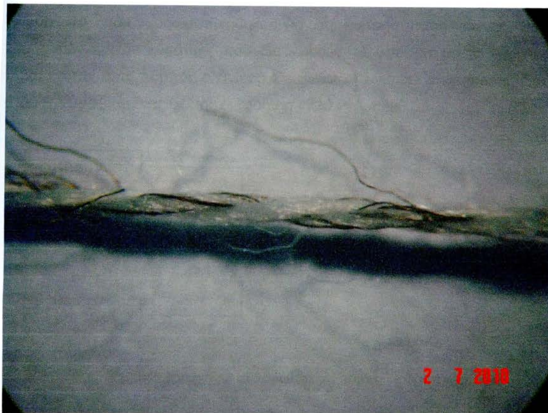
Εικόνα 8: Δίκλωνο νήμα από ακρυλικό & επικασσιτερωμένο ακρυλικό
