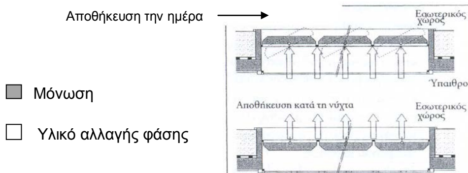
Σχήμα 15 Σχηματική παράσταση των περσίδων με υλικό αλλαγής φάσης (PCM) που δείχνουν πώς λειτουργεί το πρότυπο.
