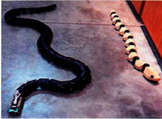
Σχήμα 10: Ρομπότ – ερπετό, που πορεύεται εξίσου τόσο στο έδαφος όσο και στο νερό
