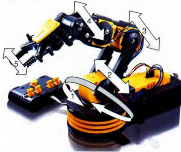
Σχήμα 15: Βαθμοί ελευθερίας ρομποτικού βραχίονα της παρούσας εργασίας
