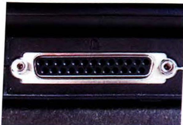
Σχήμα 43: Η παράλληλη θύρα που υιοθετήθηκε από την IBM και επικράτησε στους προσωπικούς υπολογιστές μετά το 1980.
