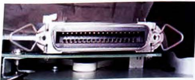
Σχήμα 42: Βύσμα 36 ακίδων (θηλυκό) που χρησιμοποιείτο για βιομηχανική χρήση και στους προσωπικούς υπολογιστές πριν του 1980.
