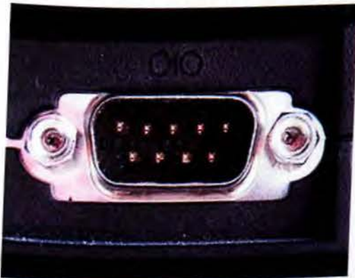
Σχήμα 36: Αρσενικό θύρας RS-232. Το συγκεκριμένο πρότυπο είναι που επικράτησε έναντι όλων των άλλων και είναι το DE-9.
