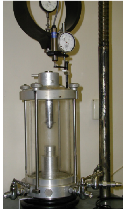
Εικόνα 7. Διάταξη τριαξονικής δοκιμής – κυψέλη, σχεδιάγραμμα (α) (Craig, Soil Mechanics), φωτογραφία (β) Εργαστήριο Δομικής Μηχανικής.Τ
