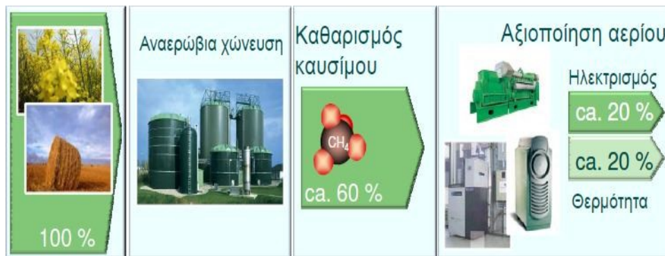
Σχήμα 2.14: Παραγωγή αερίου από αναερόβια χώνευση βιομάζας [28]
