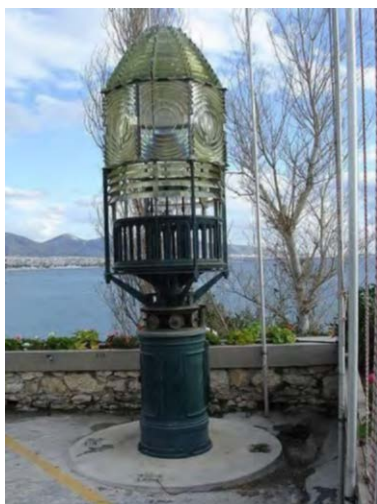
Εικόνα 13. Φαρικό οπτικό (μηχανή) τύπου Φρενέλ όπου διακρίνονται οι επάλληλοι οριζόντιοι (πάνω και κάτω) και κάθετοι ομόκεντροι δακτύλιοι (διοπτρικά στοιχεία) περιμετρικά. ( http://el.wikipedia.org/wiki/ )
