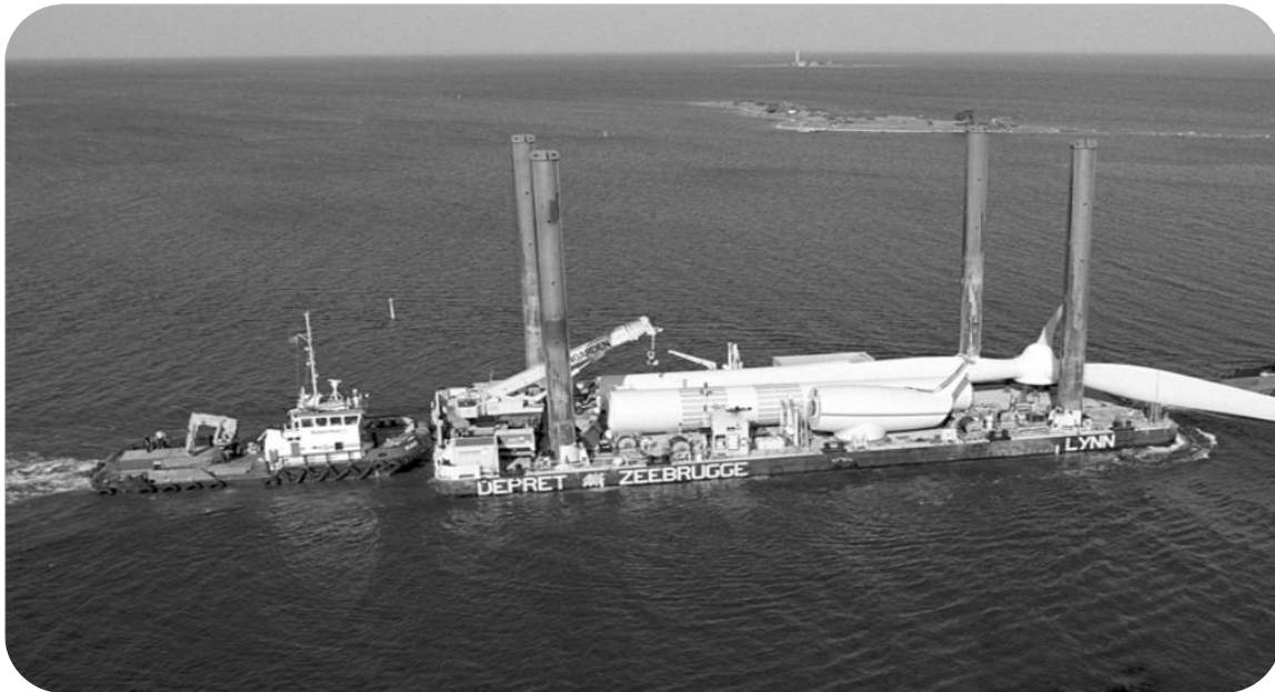
Εικόνα 3.9.2: Μεταφορά τμημάτων υπεράκτιας Α/Γ.
