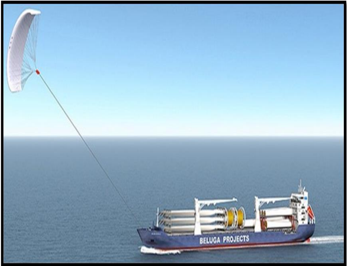
Σχήμα 4.10 Το φορτηγό πλοίο MS Beluga στο οποίο έχει τοποθετηθεί το kite SkySails
