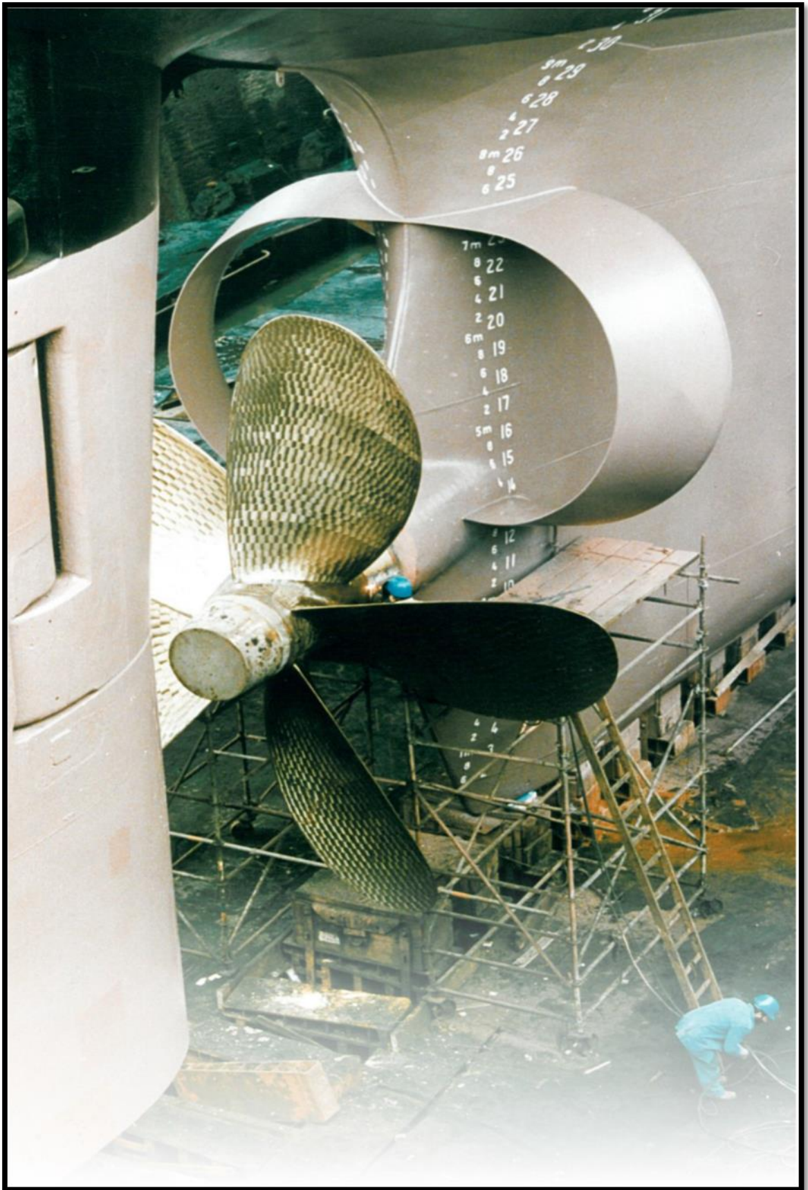
Σχήμα 4.7 Ολοκλήρωση μίας εγκατάστασης ενός SCHNEEKLUTH Duct-TET με την προπέλα τοποθετημένη
