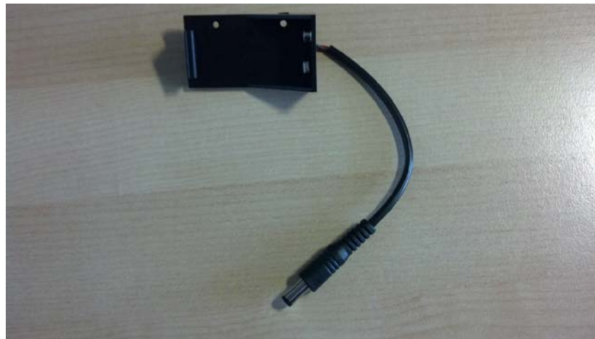
Εικόνα 49 - Θήκη υποδοχής 9V εξωτερικής μπαταρίας
