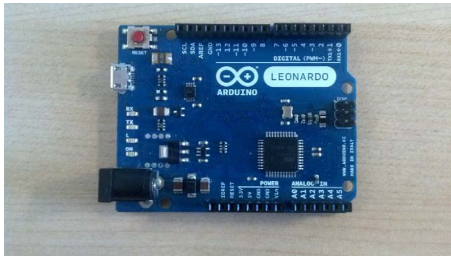
Εικόνα 43 – Πλακέτα Arduino Leonardo
