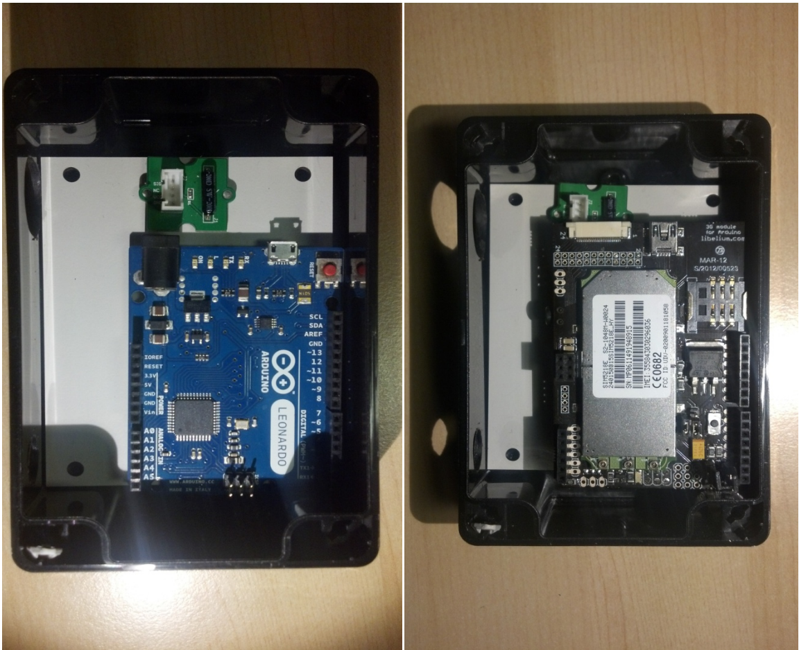
Εικόνα 52 – Τοποθέτηση Leonardo, shield και tilt switch εντός της θήκης
