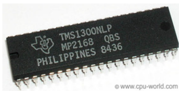
Εικόνα 4 - Μικροελεγκτής της Texas Instruments
