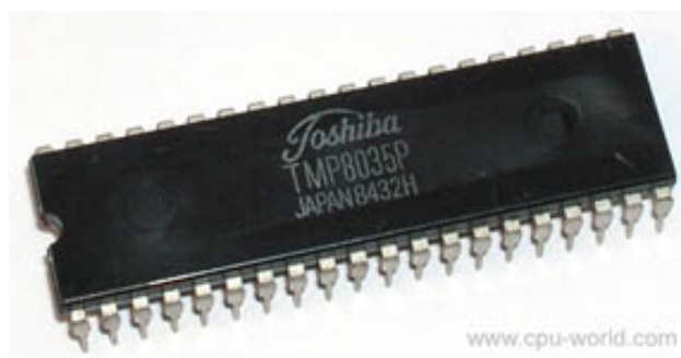
Εικόνα 5 - Μικροελεγκτής της Toshiba
