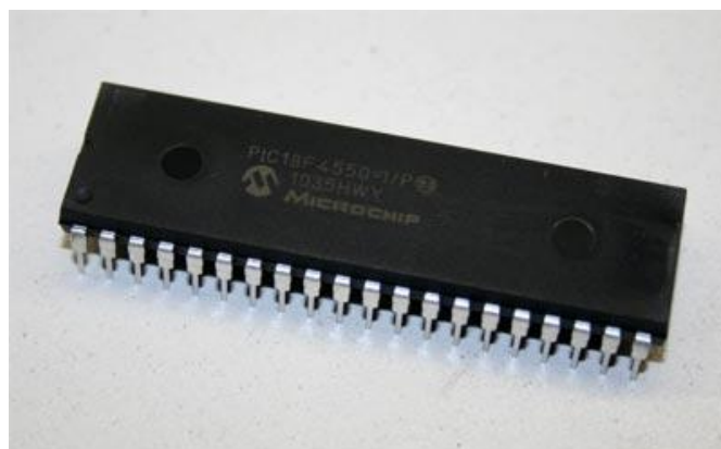
Εικόνα 2 - Μικροελεγκτής PIC της Microchip
