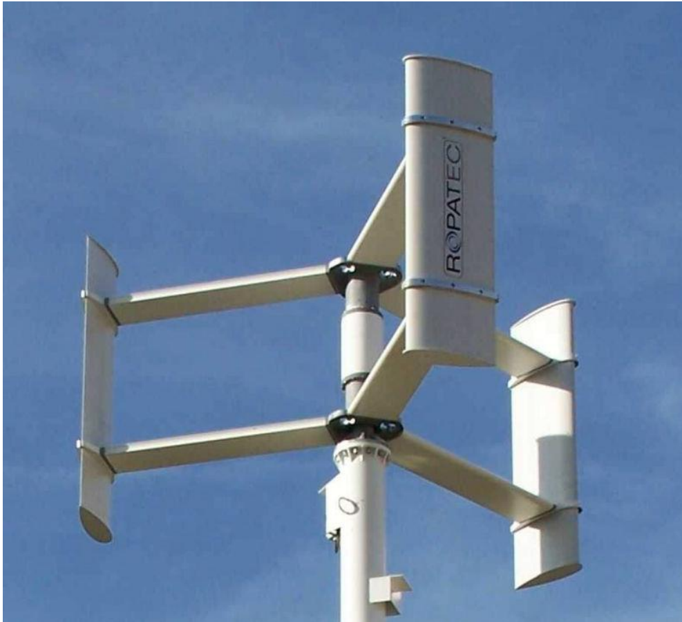
Φωτογραφία 4.1.5 Ανεμογεννήτρια κάθετου άξονα τύπου H-Darrieus Πηγή www.picstopin.com
