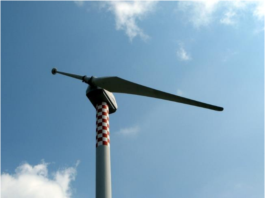
Φωτογραφία 4.3.1 Ανεμογεννήτρια οριζόντιου άξονα τύπου ΜΟΝΟΠΤΕΡΗ Πηγή www.aerotrope.com
