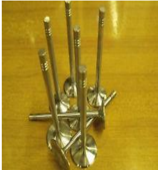
Εικόνα 32: Βαλβίδες εισαγωγής-εξαγωγής Διαστάσεων: εισαγωγής 43,50mm και εξαγωγής 38.20mm
