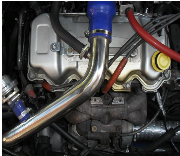
Εικόνα 62: TURBO GARRET T34.B0 + ΧΤΑΠΟΔΙ ΑΠΑΓΩΓΗΣ ΑΕΡΙΩΝ
