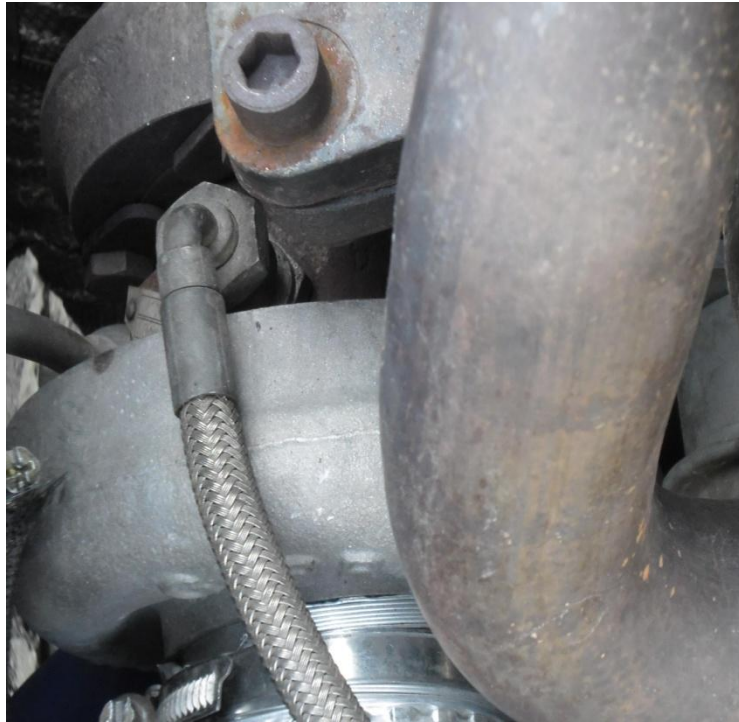
Εικόνα 46: Υπερσυμπιεστής αερίων – Turbo Garret T34.B0 με ρουλεμάν 360 μοιρών περιστροφής και σωληνώσεις απαγωγής αερίων
