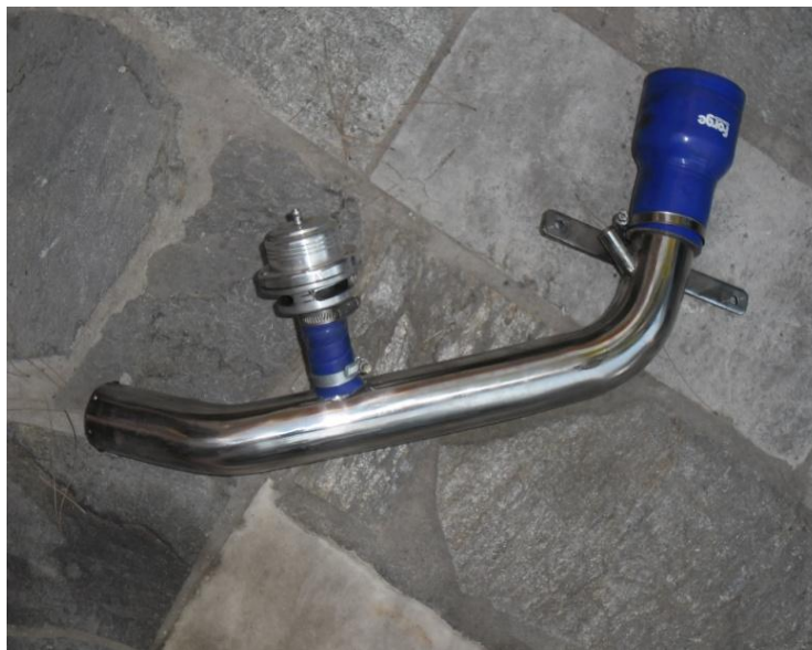
Εικόνα 45: Σωληνώσεις forge με βαλβίδα εκτόνωσης αέρα (σκάστρα)
