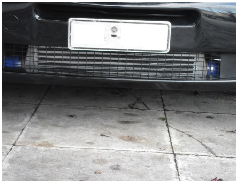
Εικόνα 64: Ψυγείο intercooler τοποθετημένο στο κάτω μέρος του προφυλακτήρα
