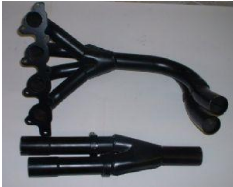
Εικόνα 24: Εξάτμιση (σύστημα απαγωγής καυσαερίων)
