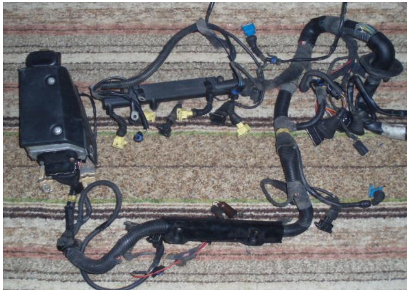
Εικόνα 48: Χειροποίητη κατασκευή καλωδίωσης
