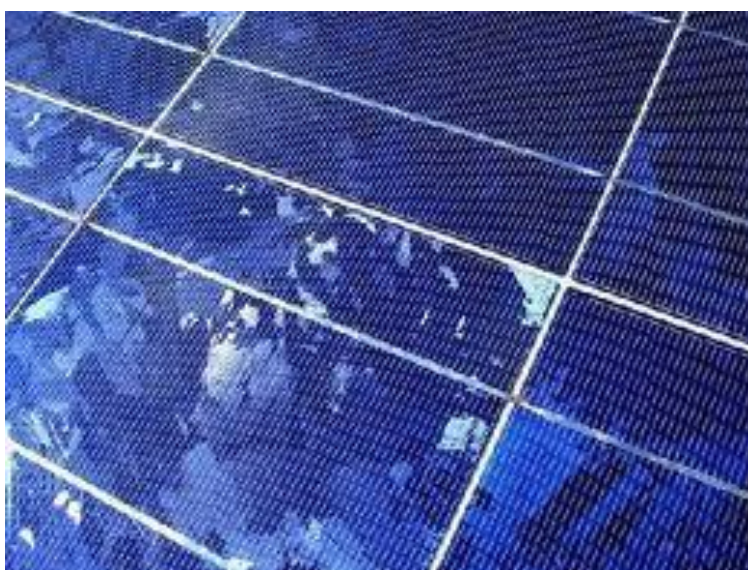
Εικόνα 11 : Φωτοβολταϊκό στοιχείο πολυκρυσταλλικού πυριτίου [ 11 ]
