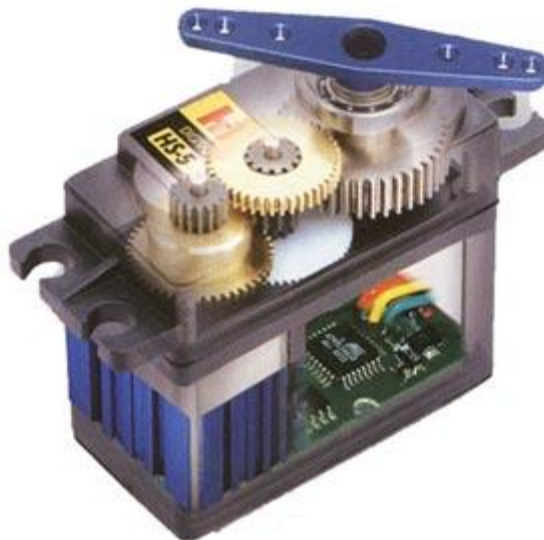
Εκόνα 24 : Τομή σερβοκινητήρα
