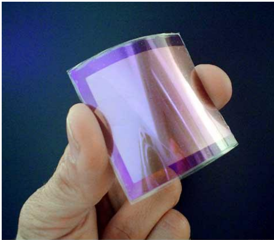
Εικόνα 13 : Φωτοβολταϊκό στοιχείο Δισεληνοϊνδιούχου χαλκού
