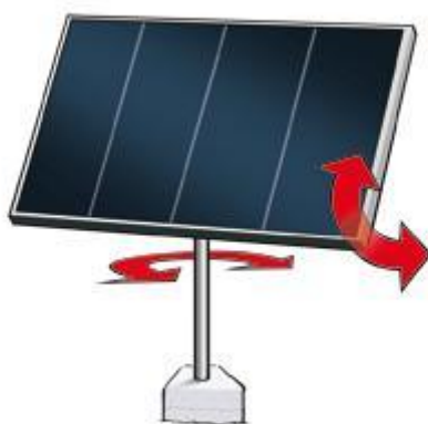
Εικόνα 21 : Φωτοβολταϊκό πάνελ με σύστημα κινητής βάσης δύο βαθμών ελευθερίας
