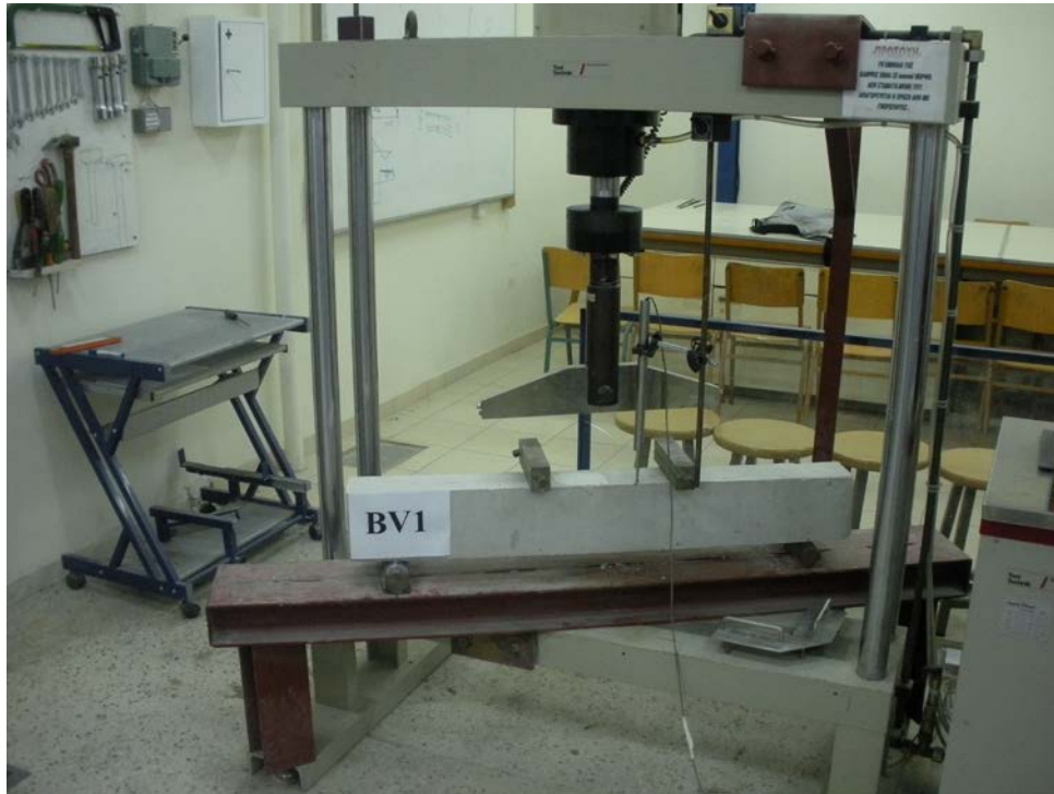
Εικόνα 4 : Υποβολή σε κάμψη του 1 ου δοκαριού.
