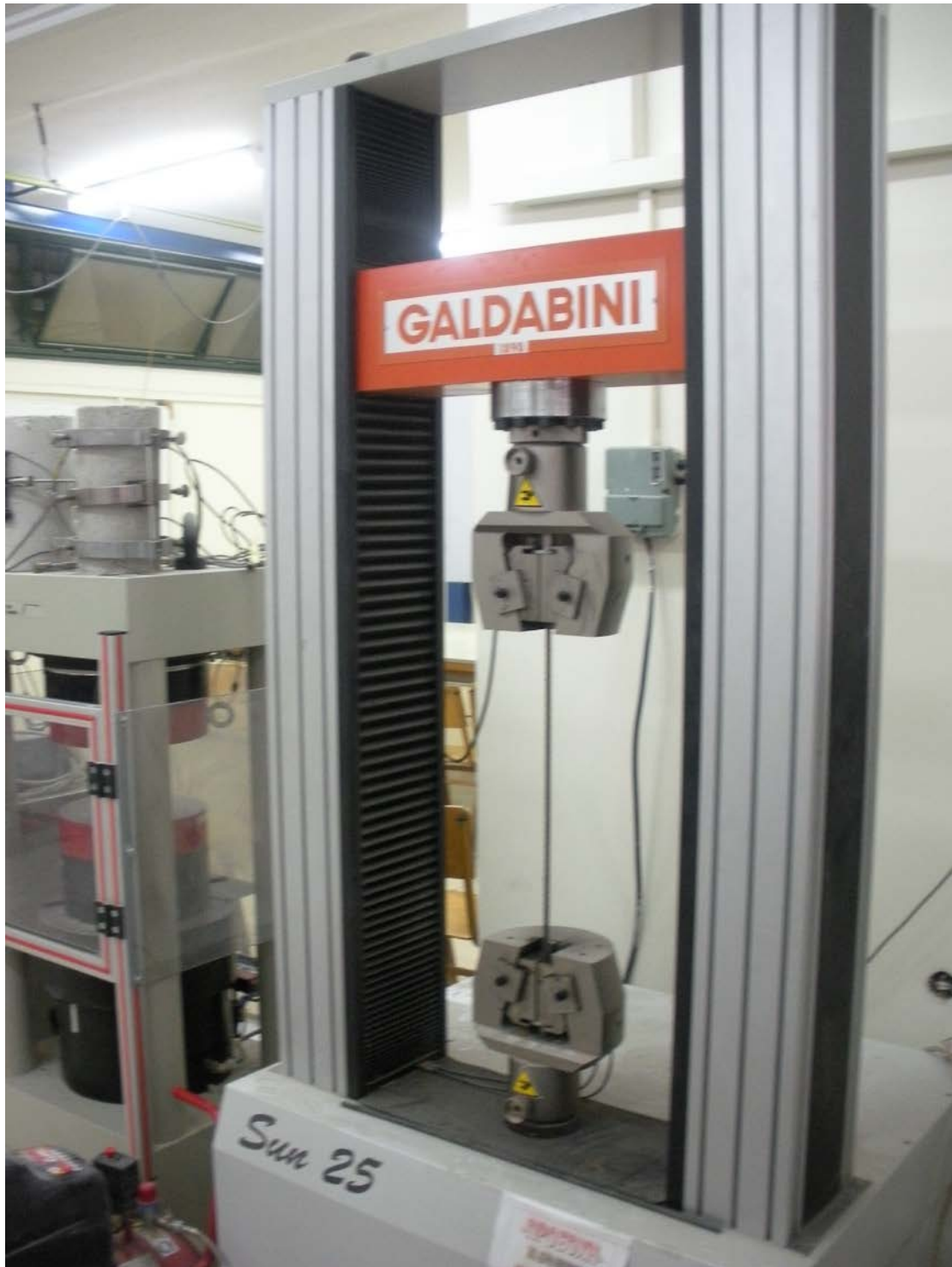
Εικόνα 14 : Ο εφέλκυσμός του οπλισμού ξεκινάει έφοσον η πάνω και η κάτω σιαγόνα κλείσει .
