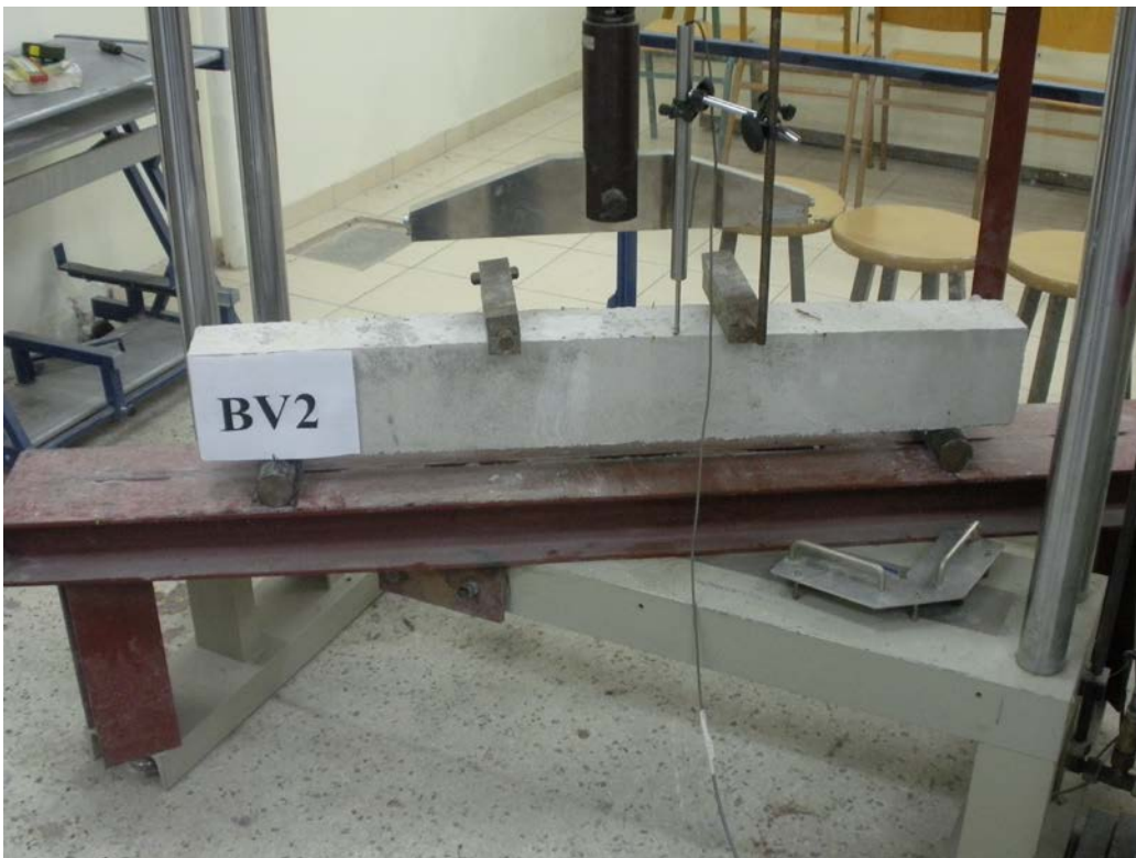
Εικόνα 9 : Υποβολή σε κάμψη 2 ου δοκαριού.
