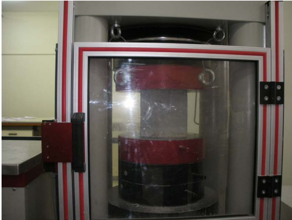
Εικόνα 3 : Σπάσιμο κυβικού δοκιμίου στην μηχανή θλίψης
