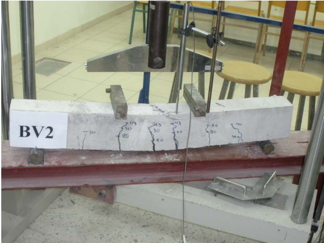
Εικόνα 12 : Κατάρρευση της δοκού και θραύση αυτής με φορτίο 43,15 KN.
