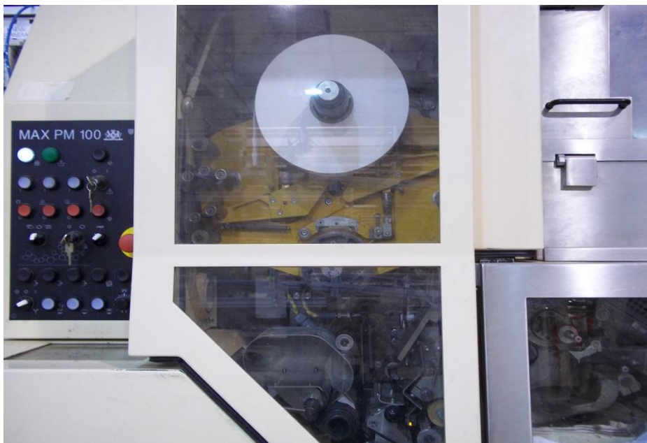
(Εικόνα 1.14): Το μέρος του επιστομίου της MAX, το χαρτί του φίλτρου που το τυλίγει
