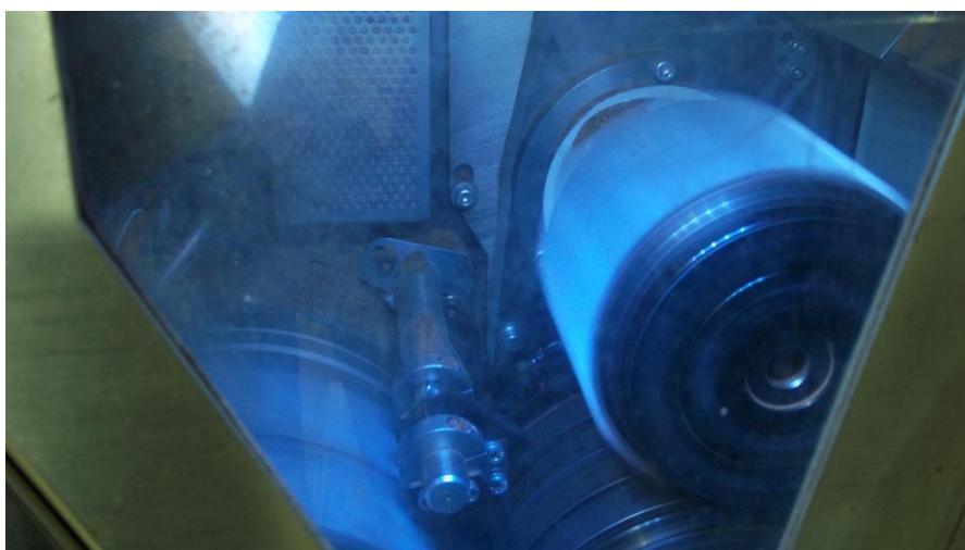
(Εικόνα 1.13): Κοπτικά που κόβουν το τσιγάρο μακαρόνι σε δύο
