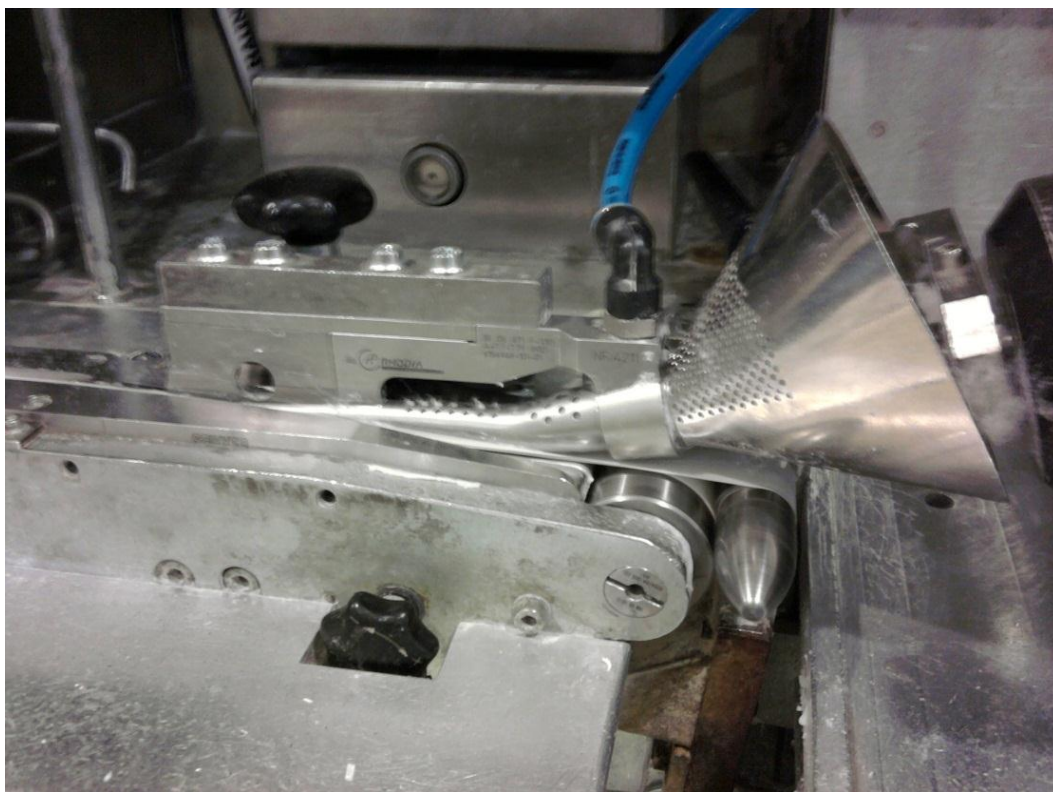
(εικόνα 3.10): Στο σημείο αυτό το υλικό του φίλτρου, συμπυκνωμένο πια, έρχεται και ντύνεται με το ειδικό χαρτί του φίλτρου, το οποίο έχει ήδη πάρει ειδική κόλλα και περνώντας από τους θερμοτήρες, κολλάει κατάλληλα και βγαίνει το φίλτρο μακαρόνι έτοιμο για να κοπεί.
