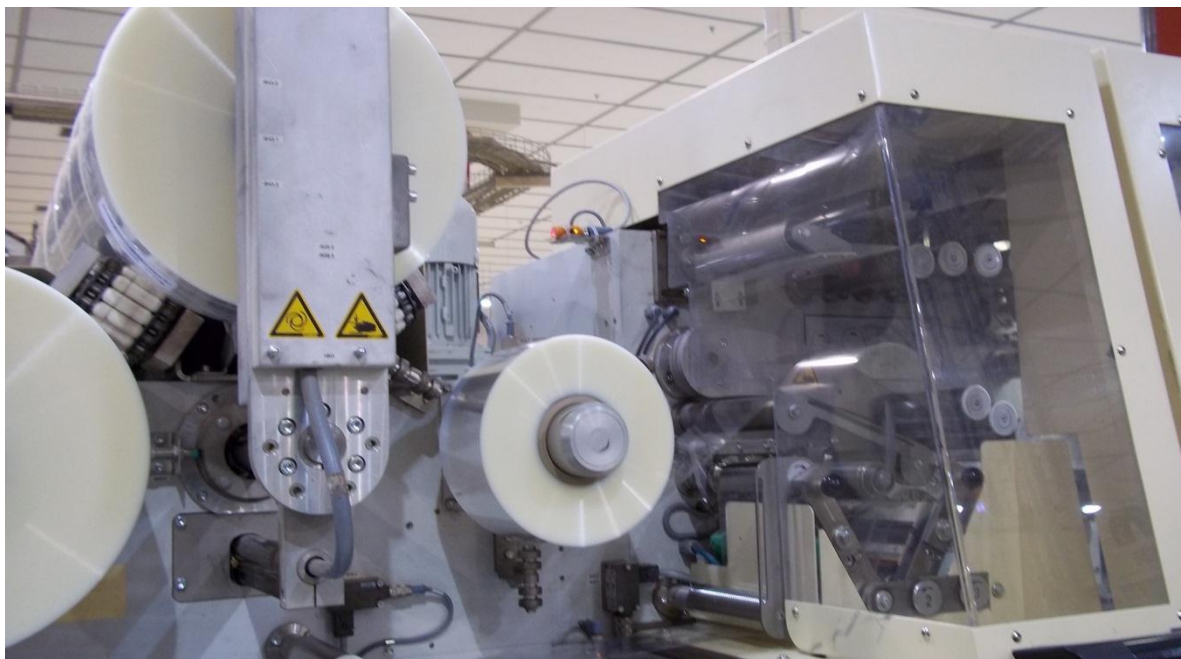
(Εικόνα 2.3): Το σελοφάν σε μπομπίνες ξετυλίγεται και δρομολογείται για το ντύσιμο των πακέτων
