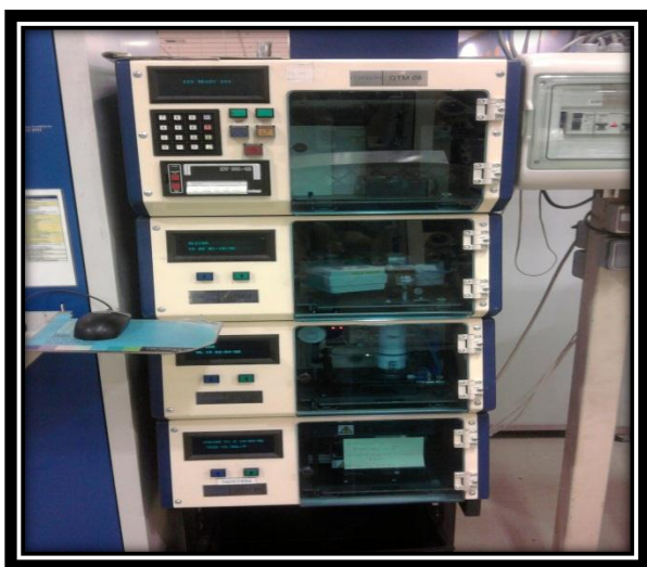
(εικόνα 3.15): QTM , περιφερειακό μηχανήμα (ποιοτικού ελέγχου) μέτρησης τσιγάρων
