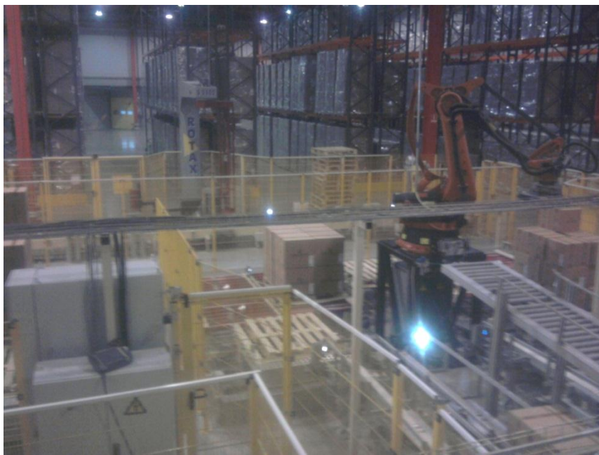
(εικόνα 3.2): Τα ρομπότ τοποθετούν τις κούτες πάνω στις παλέτες, όταν αυτές φτάνουν διαχωρισμένες σωστά μέσω των διαδρόμων από την δευτερογενή παραγωγή
