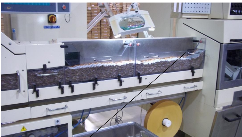
(εικόνα 1.22): διάδρομος μεταφοράς
