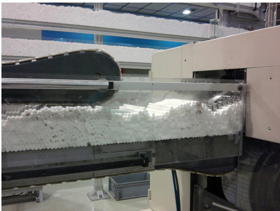
(εικόνα 3.12): Μετά την επέμβαση των κοπτικών, το φίλτρο βγαίνει και δρομολογείται μέσω των διαδρόμων μεταφοράς και οδηγείται στις κατάλληλες σωληνώσεις που θα το στείλουν, με την βοήθεια του αέρα, στην σωστή μηχανή τσιγάρου όπου και θα προσθεθεί με το το υπόλοιπο τσιγάρο στο μέρος της “MAX”
