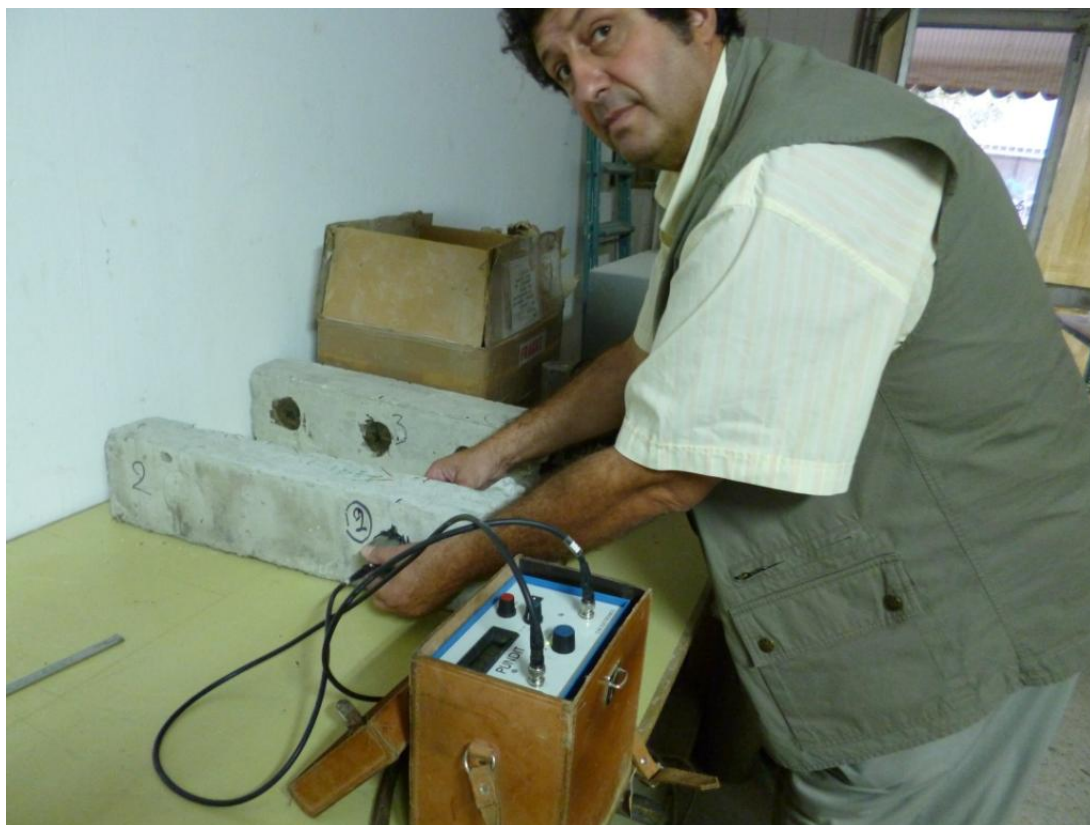
Εικόνα 9 Στιγμιότυπο κατά την εφαρμογή της συσκευής υπερήχων
