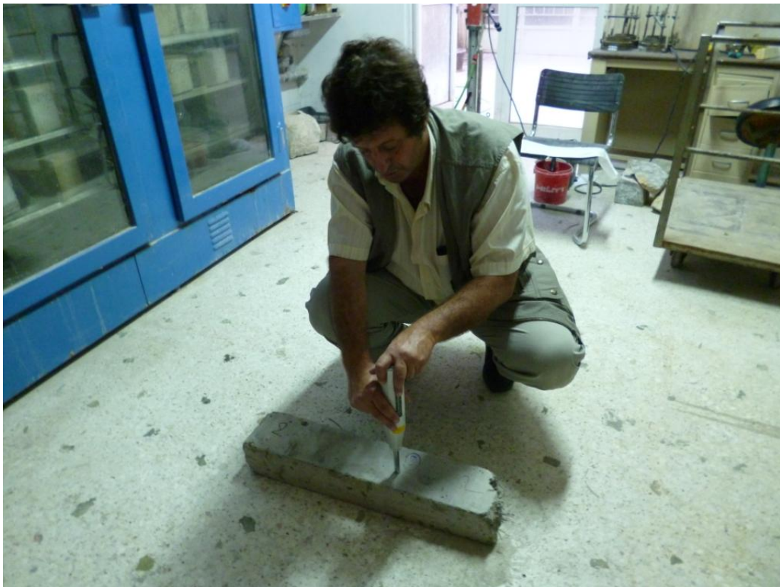
Εικόνα 7 Μετρήσεις με το κρουσίμετρο
