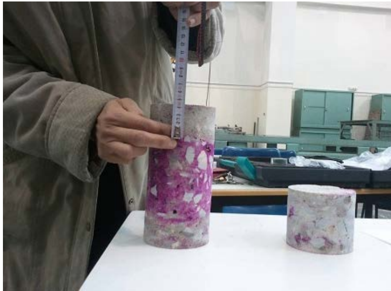
Εικόνα 1 Ημικαταστροφική μέθοδος μέτρησης ενανθράκωσης του σκυροδέματος
