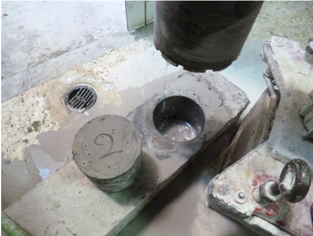
Εικόνα 5 Κατά την διαδικασία της πυρηνοληψίας, για το δεύτερο δείγμα
