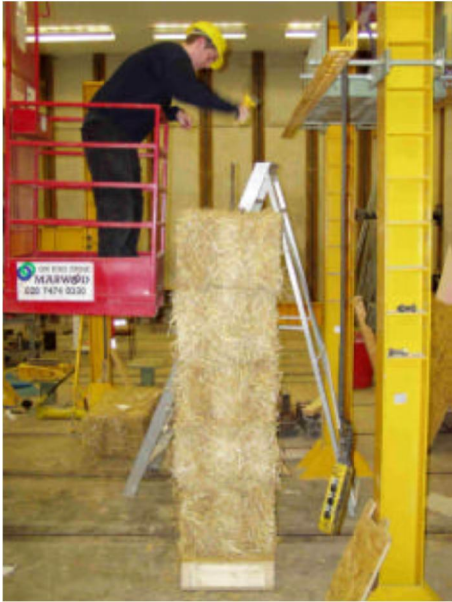
Κάθετη τοιχοποιία αχυρομπάλων 2-δεσμών
