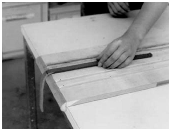
Δοκιμή συνοχής με λωρίδα πηλού (Πηγή: BUILDING WITH EARTH, Gernot Minke σελ.24
