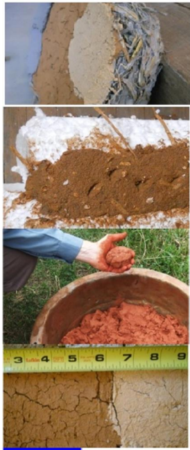
Το κατάλληλο επίχρισμα –δοκιμές εύρεσης κατάλληλου επιχρίσματος 5
