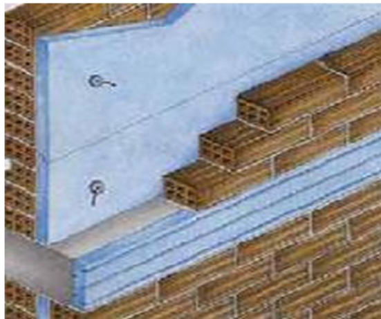
Θερμομόνωση στον πυρήνα μεταξύ δύο τοίχων.
