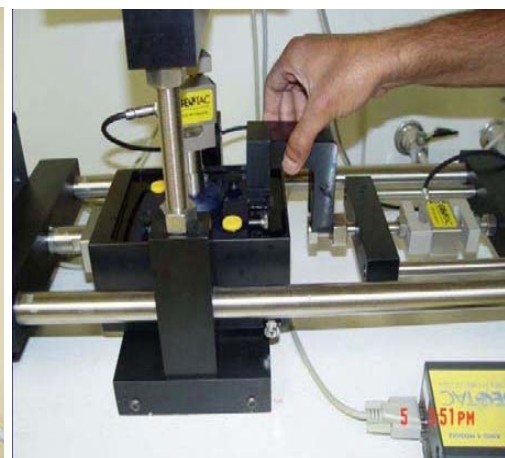
Ολοκλήρωση της σύνδεσης Αγκίστρωση του δοκιμίου έτσι ώστε το χαμηλότερο κομμάτι να μπορεί να μετακινηθεί
