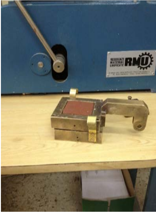
Τοποθέτηση του δοκιμίου - Εγκατάσταση του μηχανισμού σύνδεση των μηχανισμών φόρτισης φόρτισης
