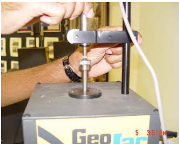
Ολοκλήρωση της σύνδεσης Αγκίστρωση του δοκιμίου έτσι ώστε το χαμηλότερο κομμάτι να μπορεί να μετακινηθεί
