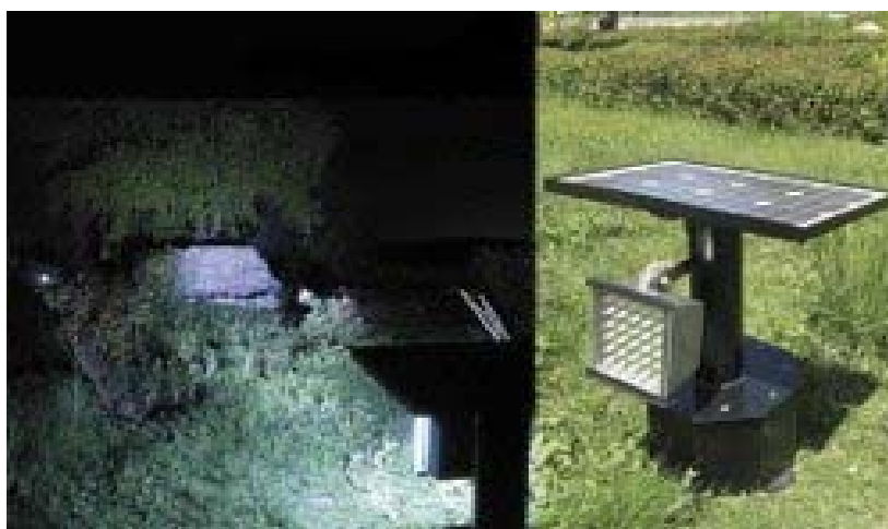
Εικόνα 24 Προβολέας μονός με ύψος: 85cm και πλάτος: 65cm. Φωτοβολταικό: 25W LED 30τ/μχ Battery: 9Ah Εκτ. Φωτεινότητας 250m 2 Αντιστ/για σε Watt 55W
