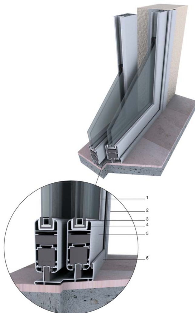
Εικόνα 76 Λεπτομέρεια κουφωμάτων αλουμινίου
