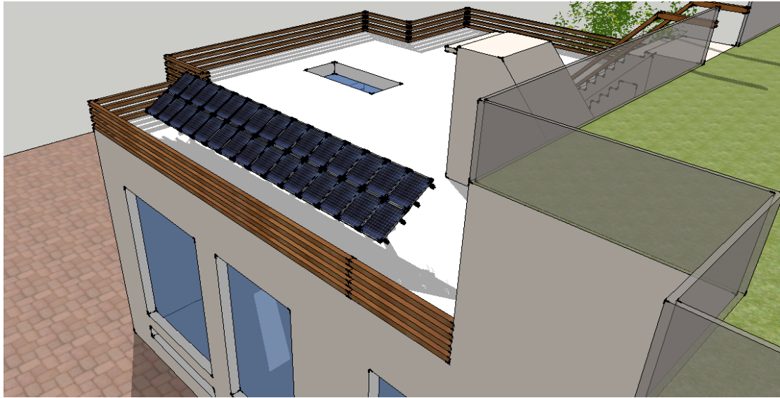
Εικόνα 72 Τα φωτοβολταϊκά τοποθετούνται στην νότια πλευρά του κτιρίου
