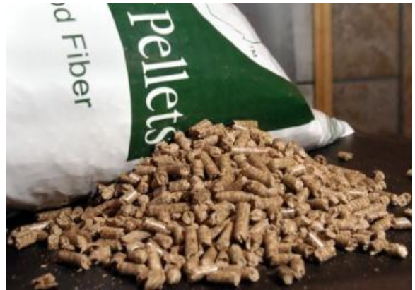
Εικόνα : Η τελική μορφή της βιομάζας ως καύσιμο (pellets).
